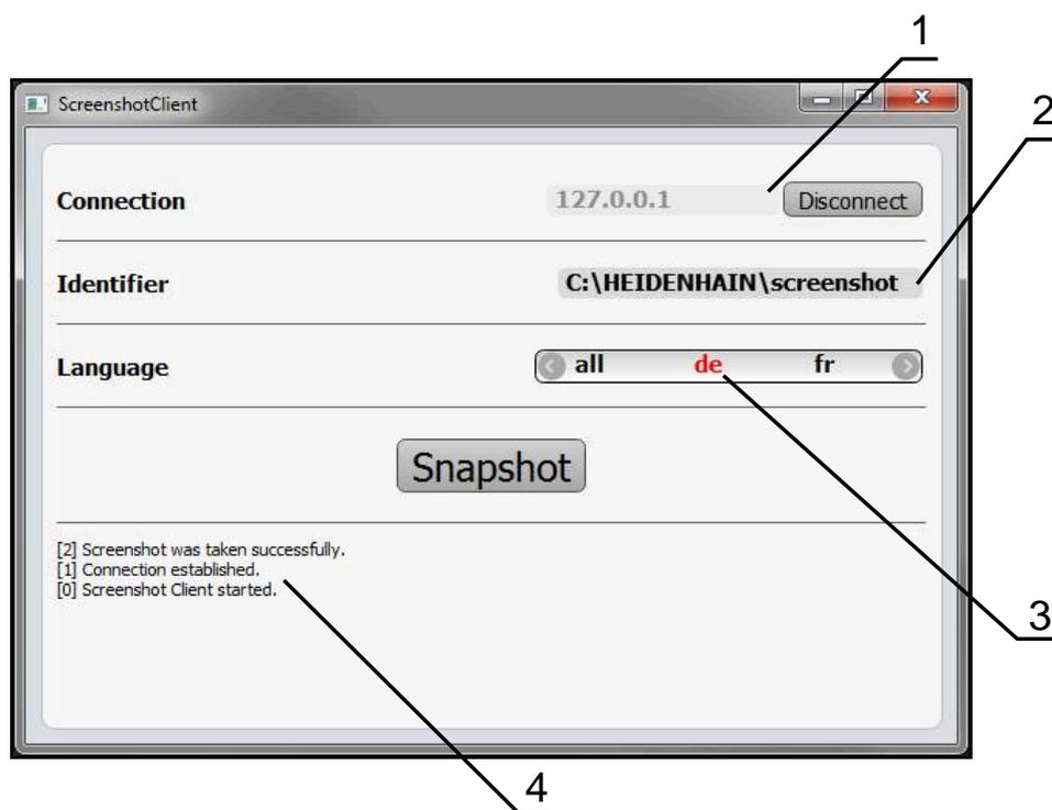
Рисунок 22: Интерфейс пользователя с ScreenshotClient
