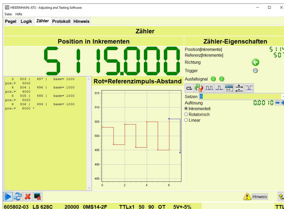
Abbildung 90: Anzeige nach der Ermittlung des Grundabstands
