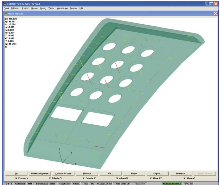
Graphische Darstellung der Messergebnisse im Modell mit Richtungspfeilen der Abweichung und den Angaben zur Abweichung
