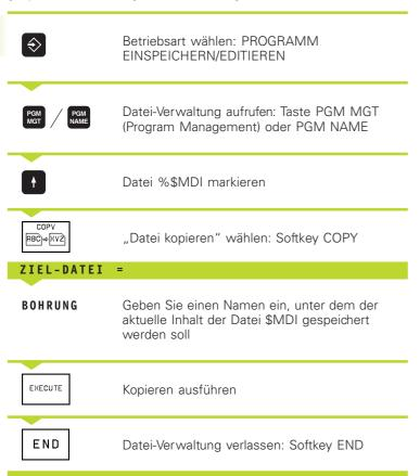
Zum Löschen des Inhalts der Datei %\$MDI gehen Sie ähnlich vor: Anstatt sie zu kopieren, löschen Sie den Inhalt mit dem Softkey DELETE. Beim nächsten Wechsel in die Betriebsart POSITIONIE-REN MIT HANDEINGABE zeigt die TNC eine leere Datei %\$MDI an.
