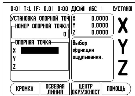
рис. I.12 Устанавливание опорных точек
