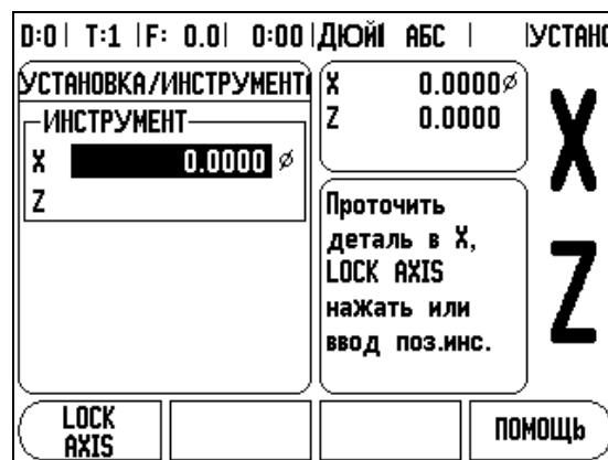
рис. I.24 Маска ввода ИНСТРУМЕНТ/УСТАНОВКА
