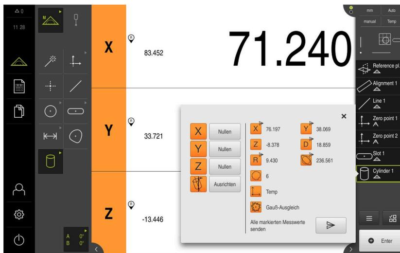
Abbildung 42: Element **Zylinder** in der Elementliste mit **Messergebnisvorschau**
