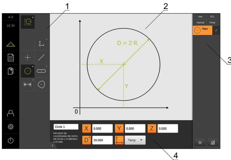
Figura 15: Función **Definir** con la geometría **Círculo**
