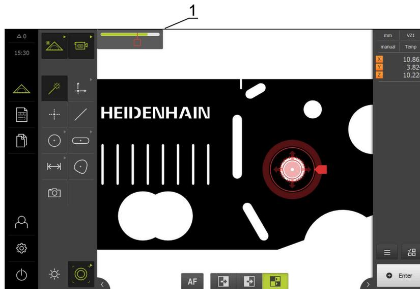
Figura 12: Menú **Medición** con **Barra de contraste**
