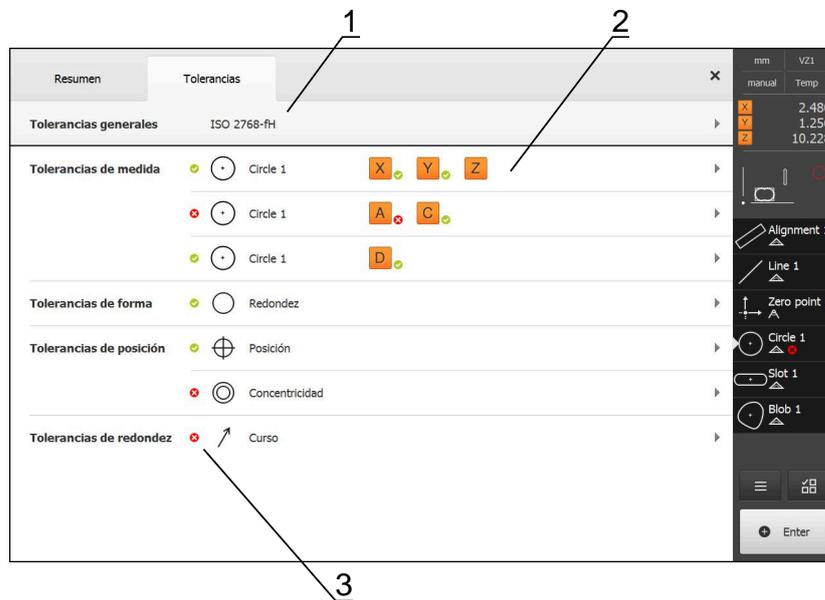
Figura 46: Diálogo **Detalles** con el registro **Tolerancias**
