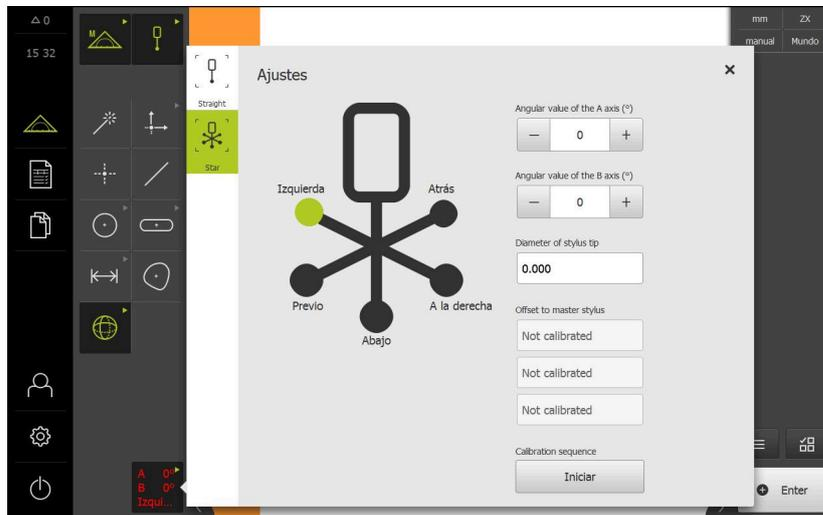
Figura 14: Diálogo **Ajustes** para herramientas de medición TP
