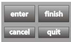
**ENTER(INVIO)** - per rilevare il punto di misura e/o per evidenziare gli elementi scelti e/o per selezionare la funzione nel menu SETUP (IMPOSTAZIONE).
