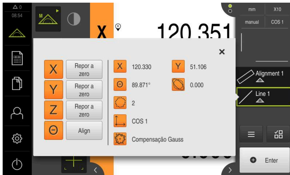
Figura 16: Selecionar o elemento Reta na lista de elementos com Pré-visualização de elementos
