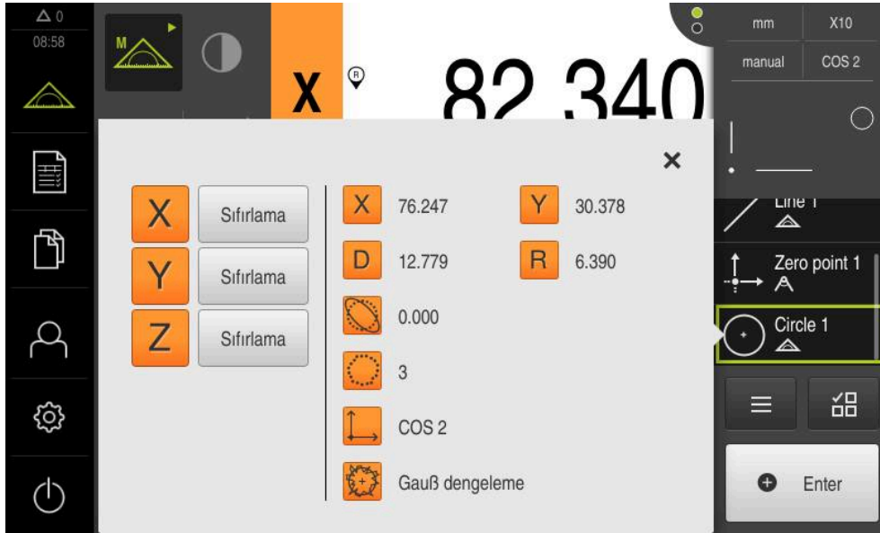
Şekil 19: Eleman Daire; Eleman önizlemesi eleman listesi
