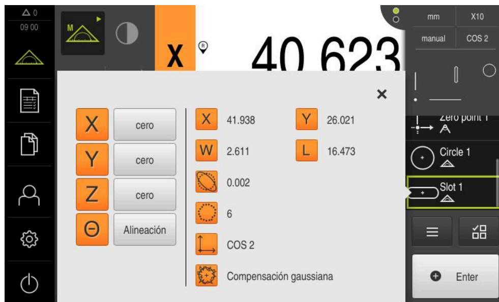
Figura 20: Elemento Ranura en la lista de elementos con Vista previa del elemento
