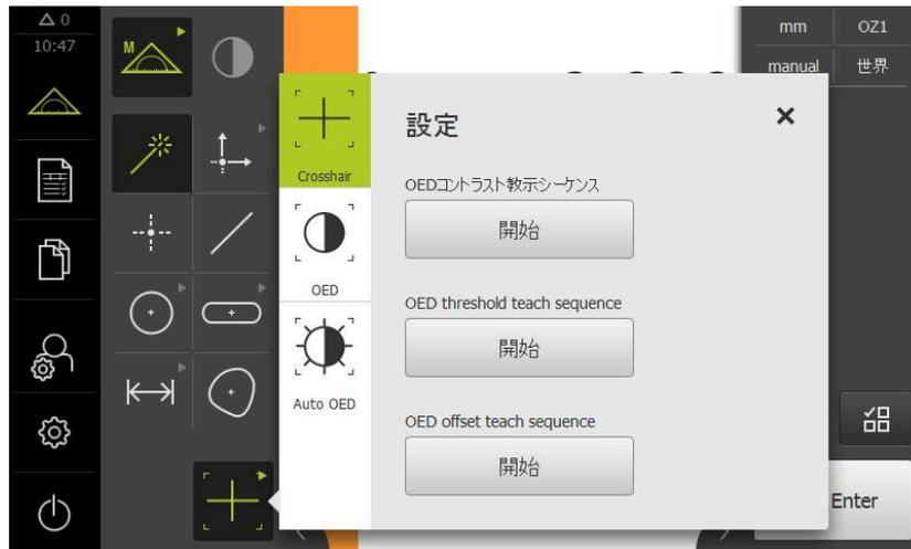
図 10: OED 測定ツール用の「設定」ダイアログボックス
