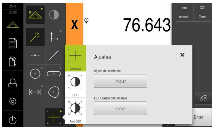
Figura 10: Diálogo **Ajustes** para herramientas de medición OED
