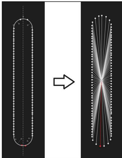
Abbildung 24: Geometriertyp von **Nut** in **Punkt** geändert
