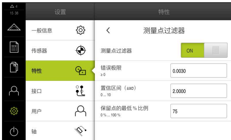
图 94: 测量点过滤器的设置
