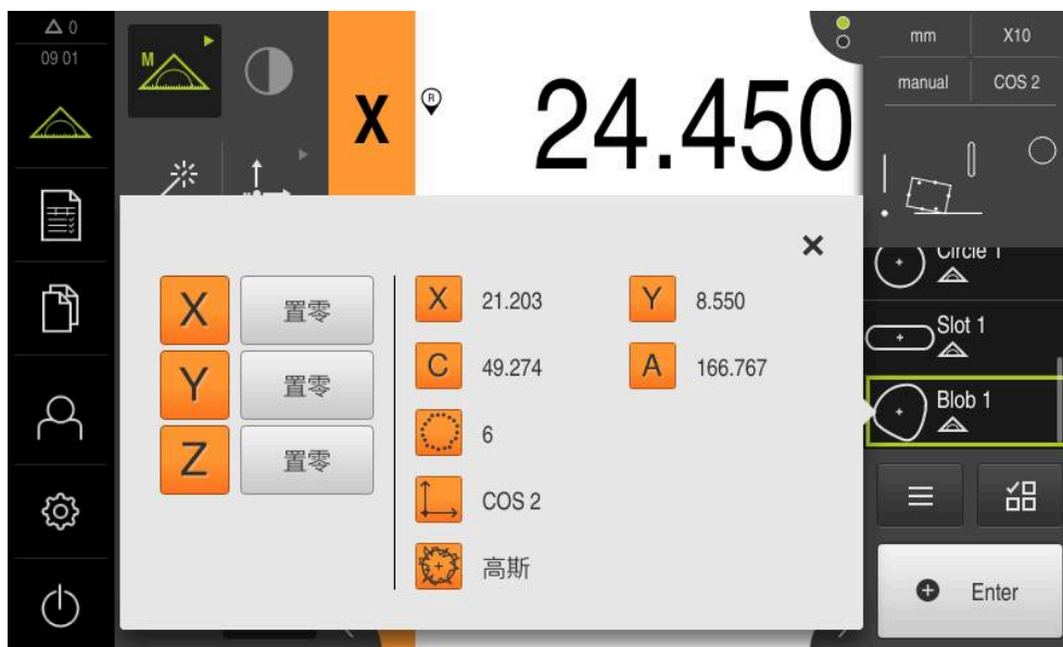
图 50: 不规则形状几何元素在测量结果预览的几何元素列表中
