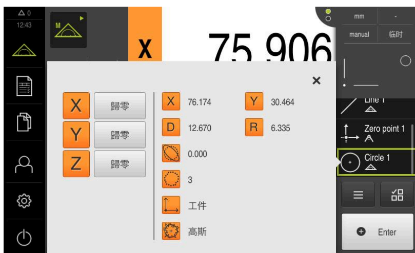
圖形 57: 圓 部件具備量測結果預覽用於不使用感測器獲取量測點
