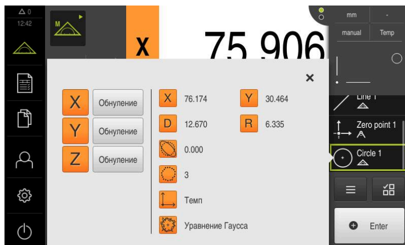
Рисунок 57: Элемент Окружность с Предварительный просмотр измерения при записи точек измерения без сенсора
