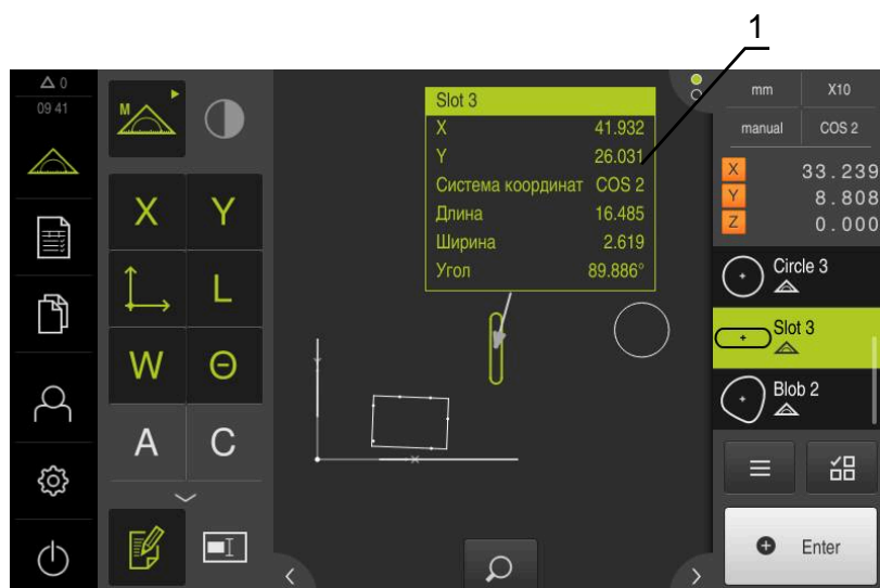
Рисунок 79: Окно элементов с информацией по измерению для одного элемента
