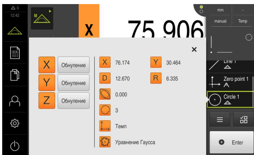
Рисунок 40: Выберите элемент Окружность в списке элементов при помощи Предварительный просмотр измерения
