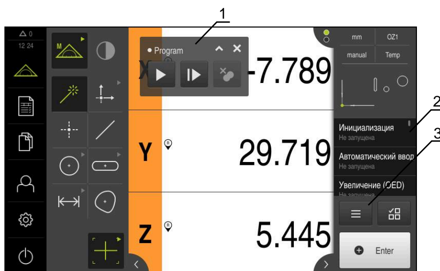
Рисунок 87: Отображение и элементы управления программ измерения
