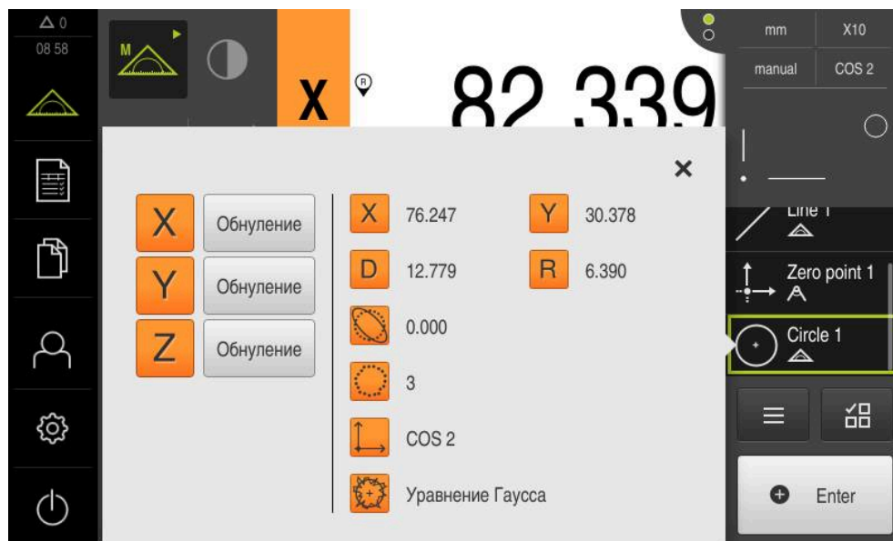
Рисунок 48: Выберите элемент Окружность в списке элементов при помощи Предварительный просмотр измерения
