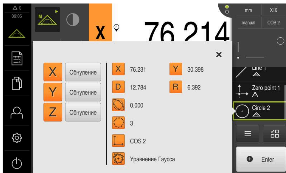
Рисунок 58: Элемент Окружность с Предварительный просмотр измерения при записи точек измерения с использованием измерительного инструмента OED Перекрестие
