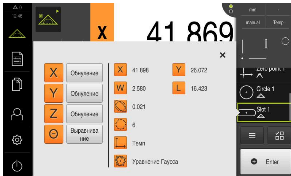
Рисунок 41: Выберите элемент Паз в списке элементов при помощи Предварительный просмотр измерения
