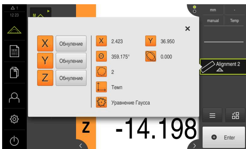
Рисунок 36: Выберите элемент Выравнивание в списке элементов при помощи Предварительный просмотр измерения
