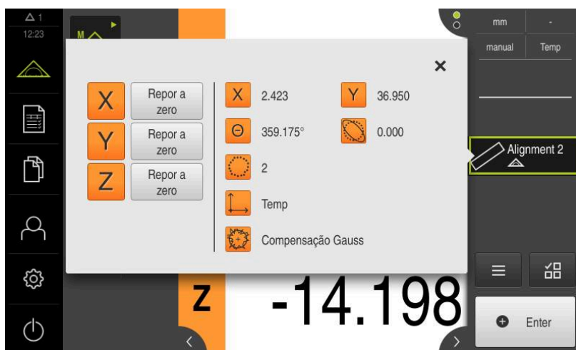
Figura 36: Selecionar o elemento Alinhamento na lista de elementos com Pré-visualização de elementos
