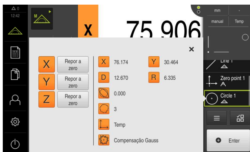
Figura 40: Selecionar o elemento Círculo na lista de elementos com Pré-visualização de elementos
