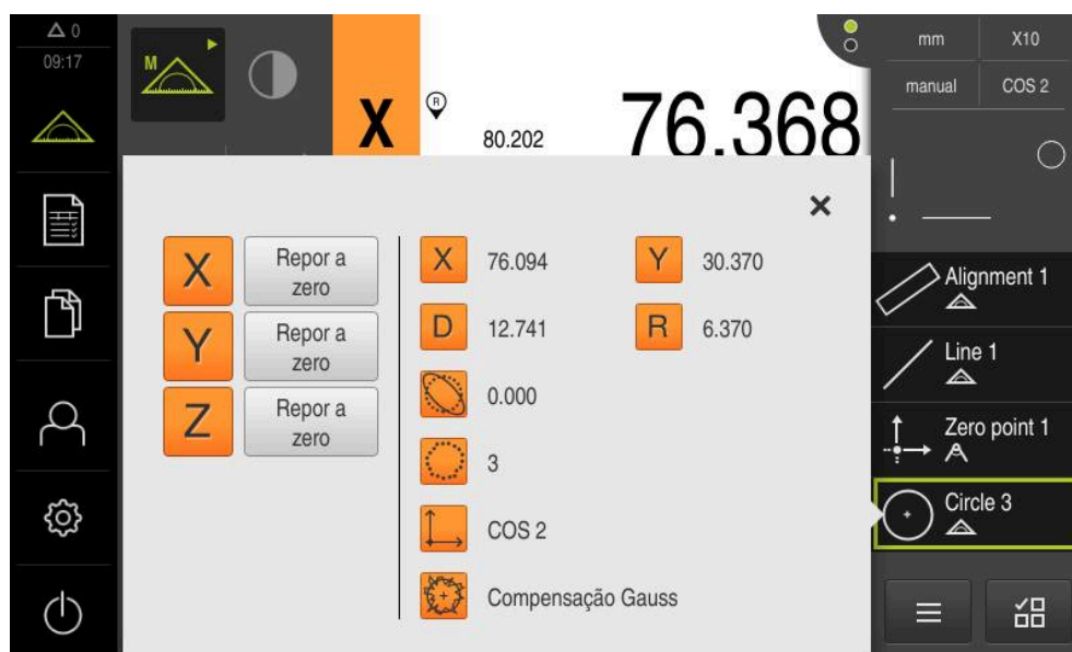
Figura 59: Elemento Círculo com Pré-visualização de elementos no registo de pontos de medição com ferramenta de medição OED ativa
