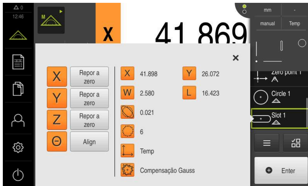
Figura 41: Selecionar o elemento Ranhura na lista de elementos com Pré-visualização de elementos
