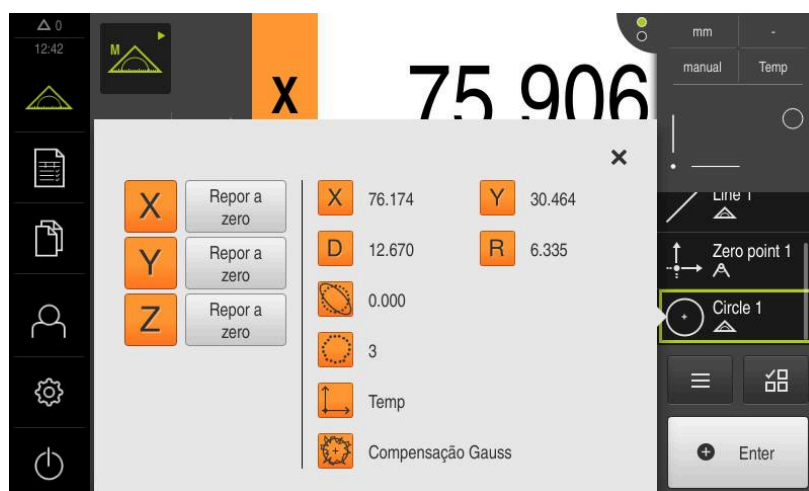
Figura 57: Elemento Círculo com Pré-visualização de elementos no registo de pontos de medição sem sensor
