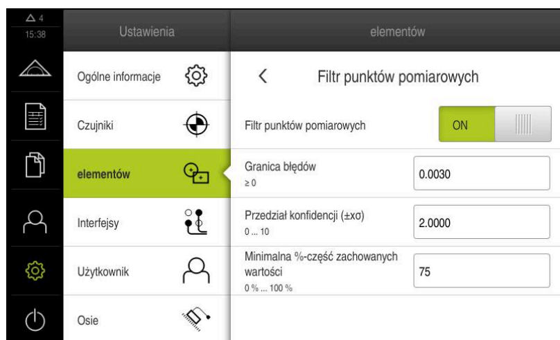
Ilustracja 94: Ustawienia filtra punktu pomiarowego
