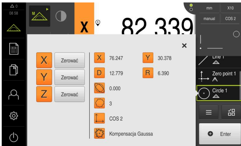
Ilustracja 48: Element Okrąg na liście elementów z Pogląd elementu
