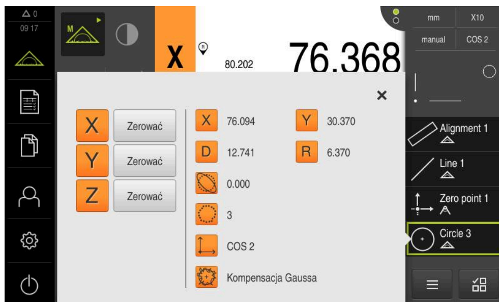
Ilustracja 59: Element Okrąg z Pogląd elementu przy rejestrowaniu punktów pomiarowych za pomocą aktywnego narzędzia pomiarowego OED
