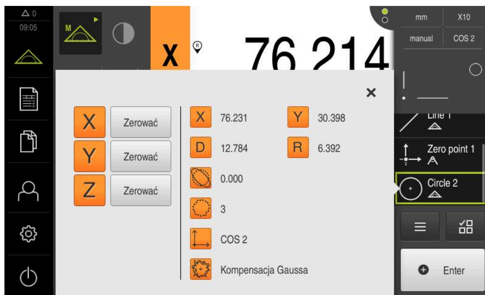
Ilustracja 58: Element Okrąg z Pogląd elementu przy rejestrowaniu punktów pomiarowych za pomocą narzędzia pomiarowego OED krzyż nitkowy
