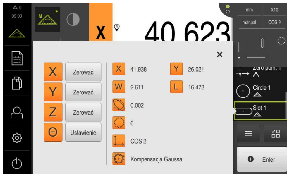
Ilustracja 49: Element Rowek wpustowy na liście elementów z Pogląd elementu
