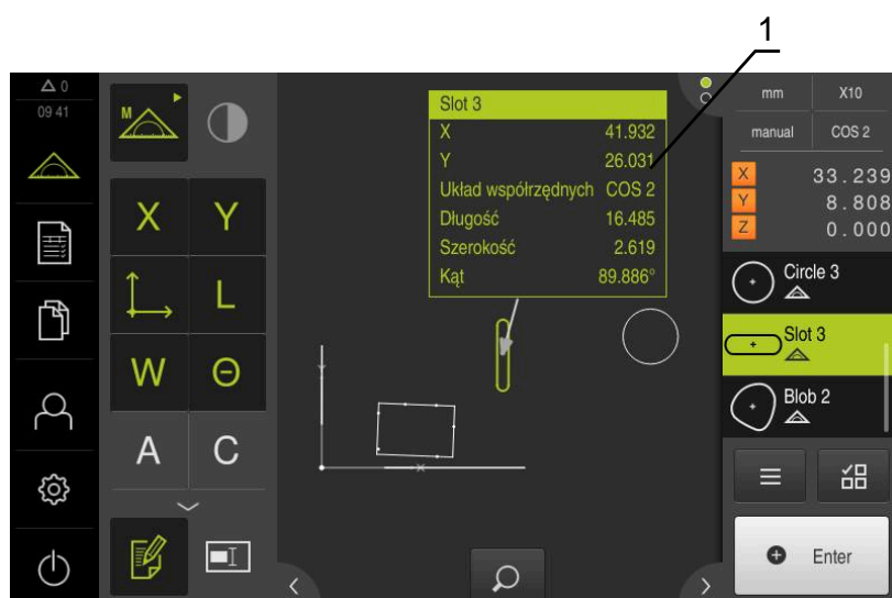
Ilustracja 79: Podgląd elementów z informacjami dotyczącymi pomiaru odnośnie danego elementu
