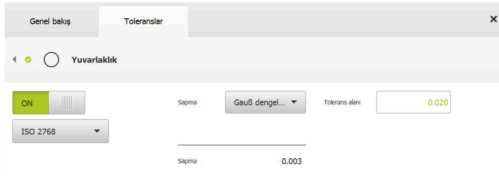
Şekil 75: ISO 2768 uyarınca etkinleştirilmiş Yuvarlaklık toleranslı Form toleransları için genel bakış
