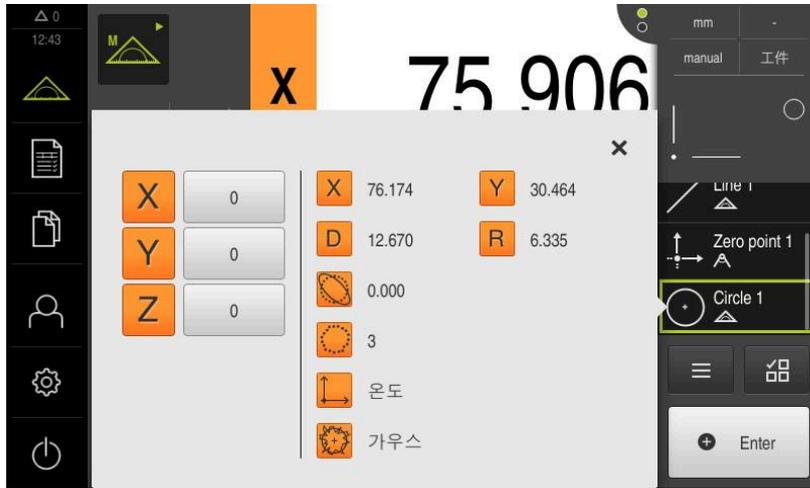
그림 57: 센서 없이 측정점 수집을 위한 형상 미리보기 포함 원 형상
