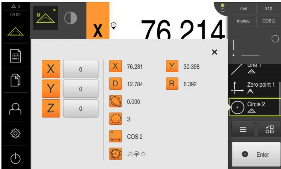
그림 58: 십자선 OED 측정 툴로 측정점 수집을 위한 형상 미리보기 포함 원 형상
