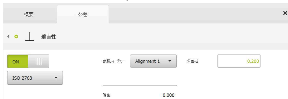
図 77: ISO 2768 に準拠する「垂直性」公差が有効化された「方向公差」一覧
