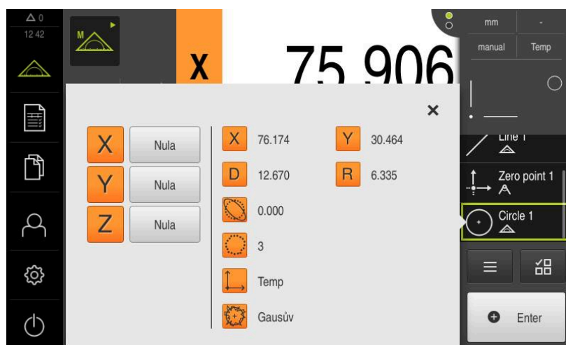
Obrázek 57: Prvek Kružnice s Náhled prvku při snímání měřicích bodů bez senzoru
