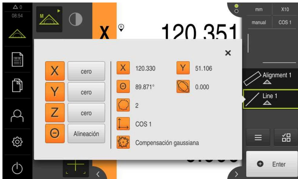
Figura 45: Elemento **Recta** en la lista de elementos con **Vista previa del elemento**
