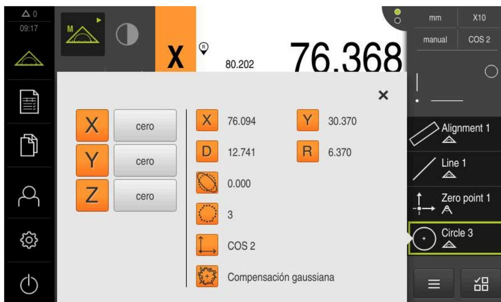
Figura 59: Elemento **Círculo** con **Vista previa del elemento** en captura de puntos de medición con herramienta de medición OED activa
