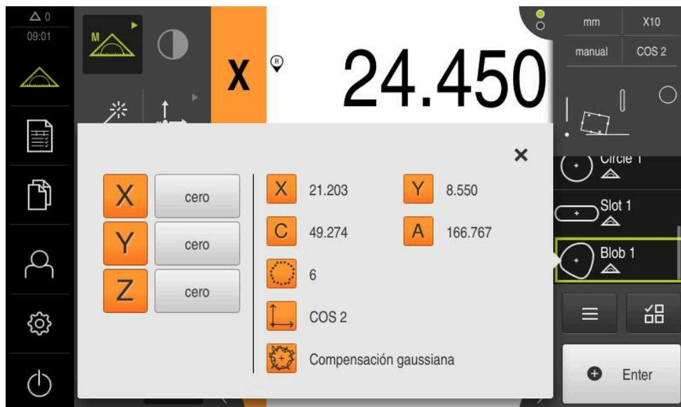
Figura 50: Elemento **Centro de gravedad** en la lista de elementos con **Vista previa del elemento**
