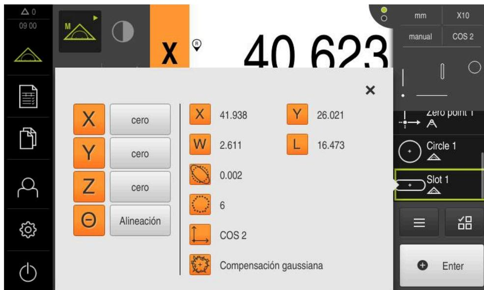
Figura 49: Elemento **Ranura** en la lista de elementos con **Vista previa del elemento**
