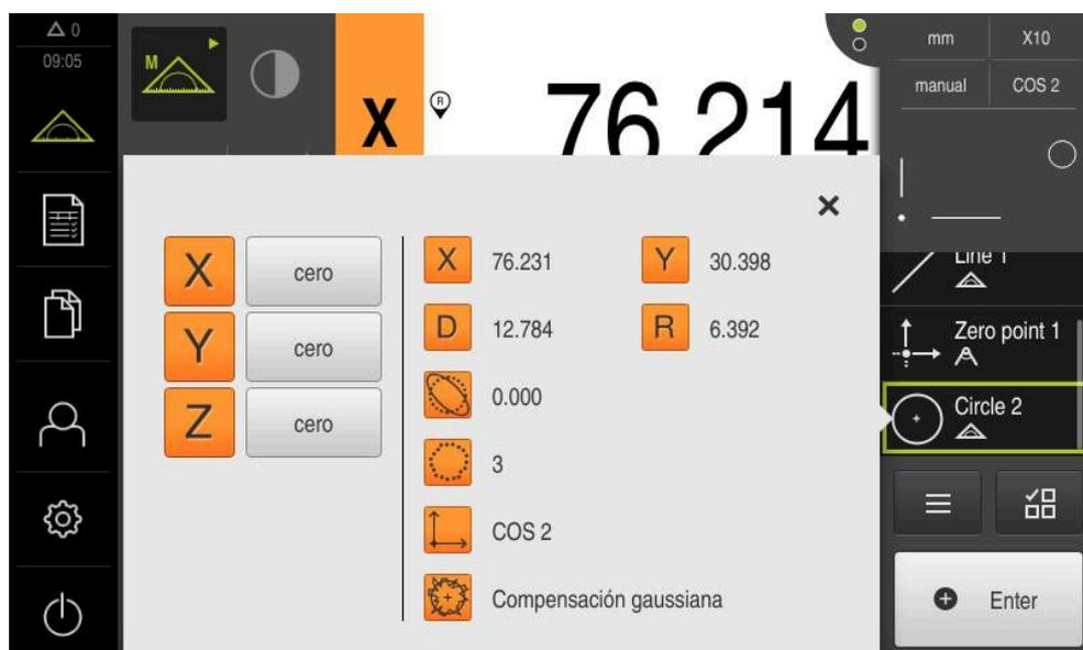
Figura 58: Elemento **Círculo** con **Vista previa del elemento** en captura de puntos de medición con herramienta de medición OED **Cruz reticular**
