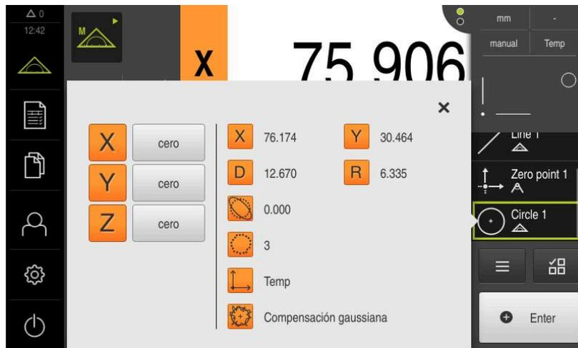
Figura 57: Elemento **Círculo** con **Vista previa del elemento** en captura de puntos de medición sin sensor
