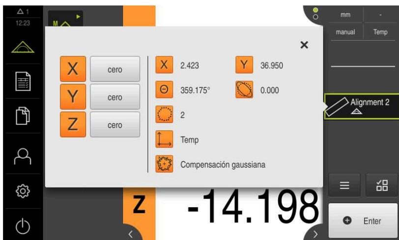
Figura 36: Elemento **Alineación** en la lista de elementos con **Vista previa del elemento**
