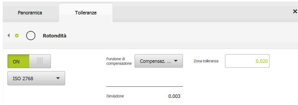
Figura 75: panoramica Tolleranze di forma con tolleranza attiva Rotondità secondo ISO 2768
