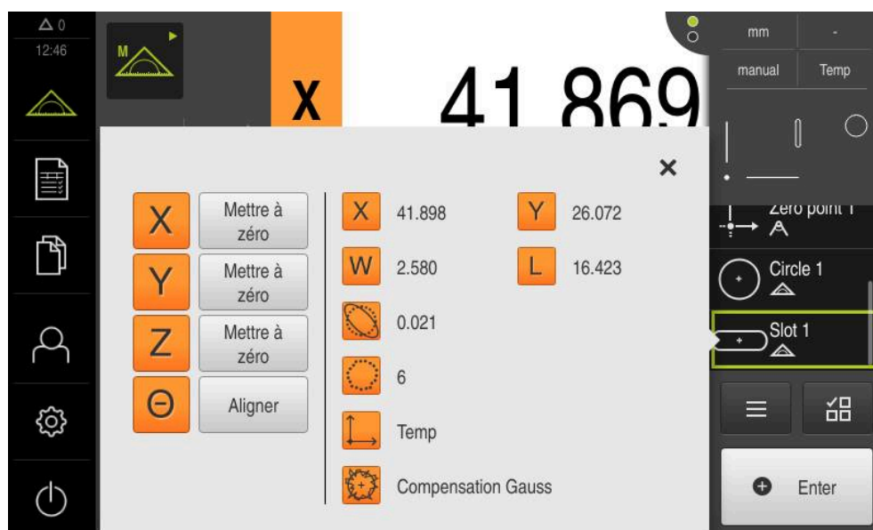
Illustration 41 : Élément Rainure dans la liste des éléments, avec l' Aperçu des fonctionnalités
