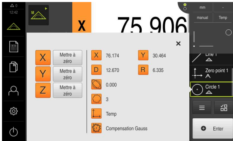
Illustration 57 : Élément Cercle avec l' Aperçu des fonctionnalités , après un enregistrement des points de mesure sans capteur
