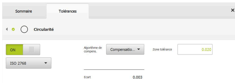
Illustration 75 : Vue d'ensemble des Tolérances de forme avec la tolérance Circularité activée selon ISO 2768
