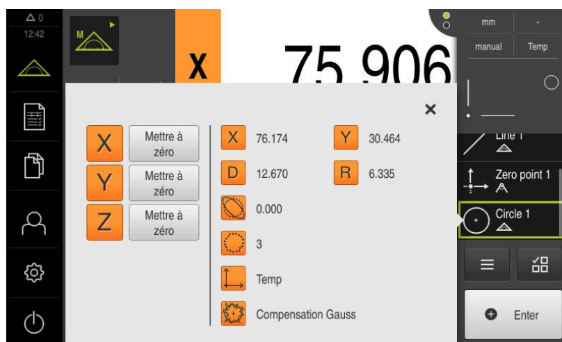
Illustration 40 : Élément Cercle dans la liste des éléments, avec l' Aperçu des fonctionnalités
