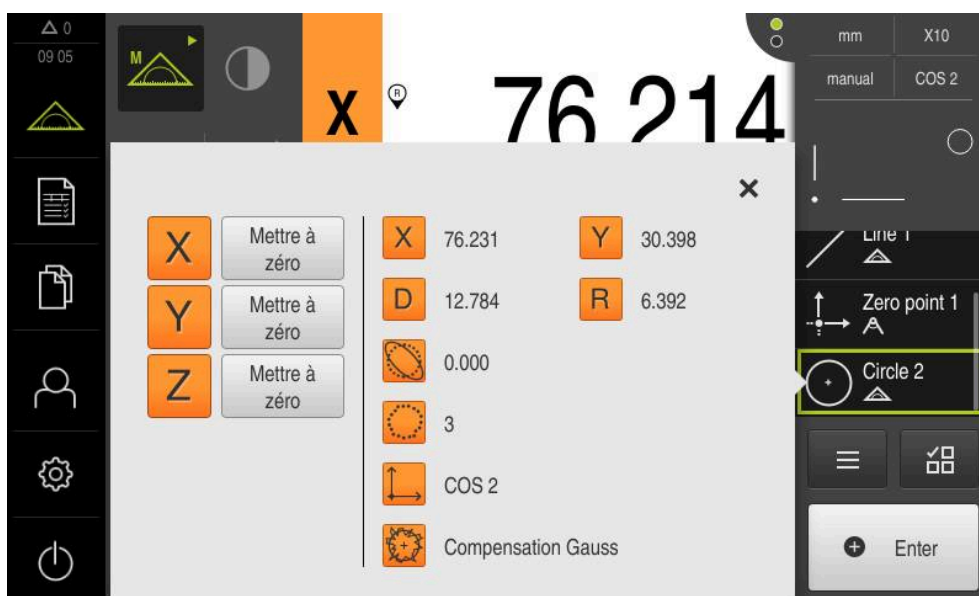
Illustration 58 : Élément Cercle avec l' Aperçu des fonctionnalités , après un enregistrement des points de mesure avec l'outil OED Réticule
