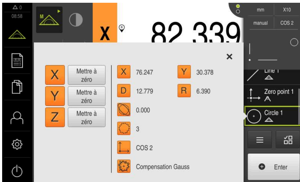
Illustration 48 : Élément Cercle dans la liste des éléments, avec l' Aperçu des fonctionnalités
