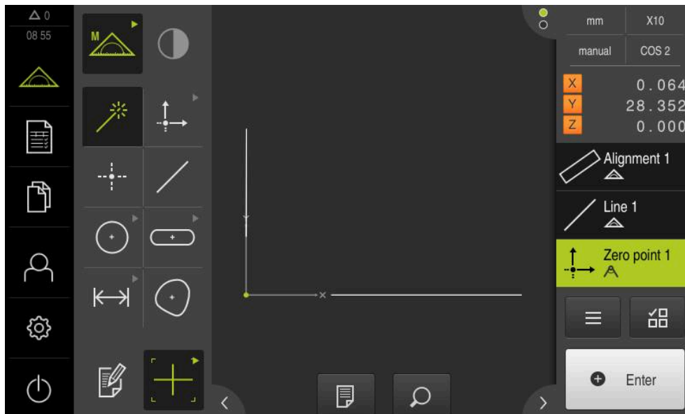
Illustration 46 : Zone de travail avec le point zéro du système de coordonnées affiché
