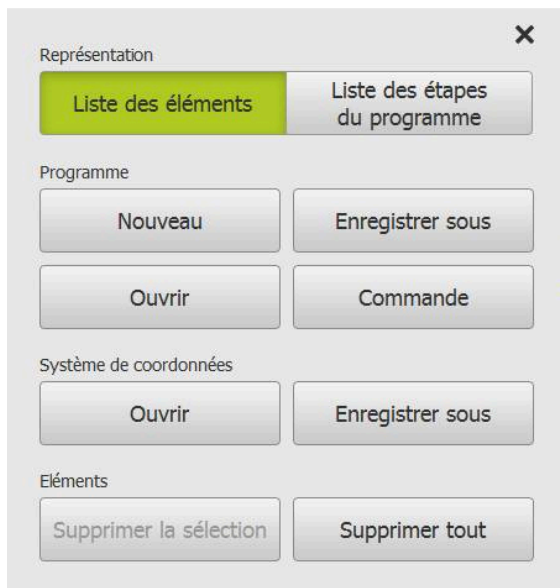
Illustration 88 : Eléments de commande de programmes de mesure dans la boîte de dialogue des fonctions auxiliaires
