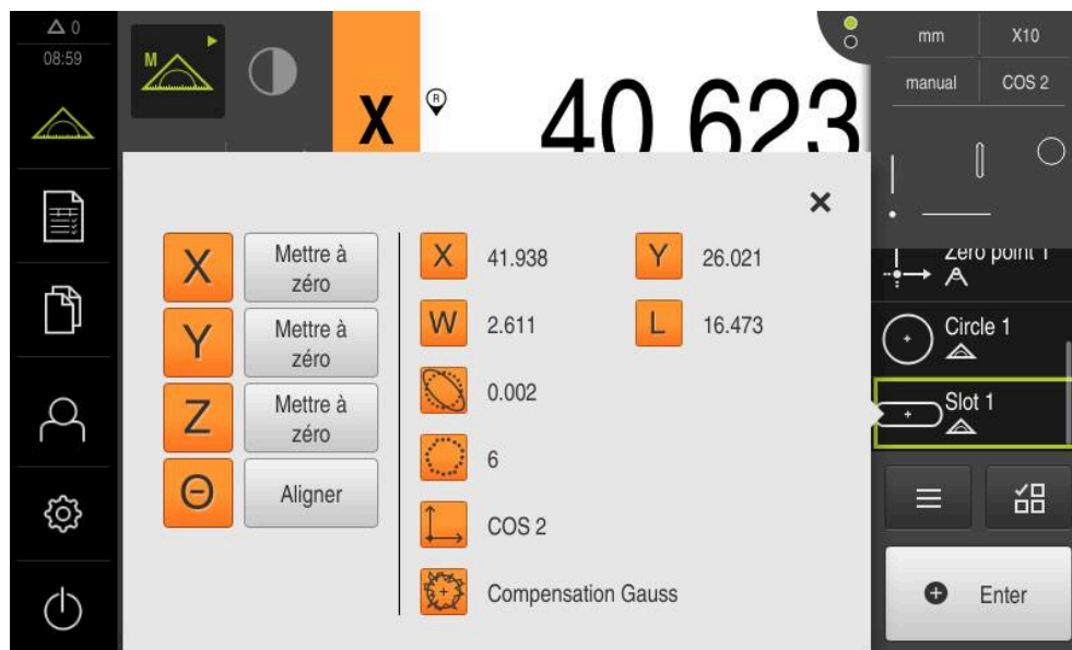
Illustration 49 : Élément Rainure dans la liste des éléments, avec l' Aperçu des fonctionnalités
