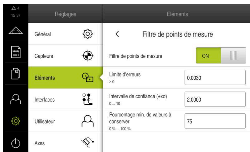
Illustration 94 : Réglages du filtre de points de mesure
