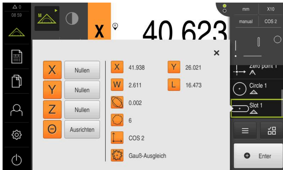
Abbildung 49: Element Nut in der Elementliste mit Messergebnisvorschau
