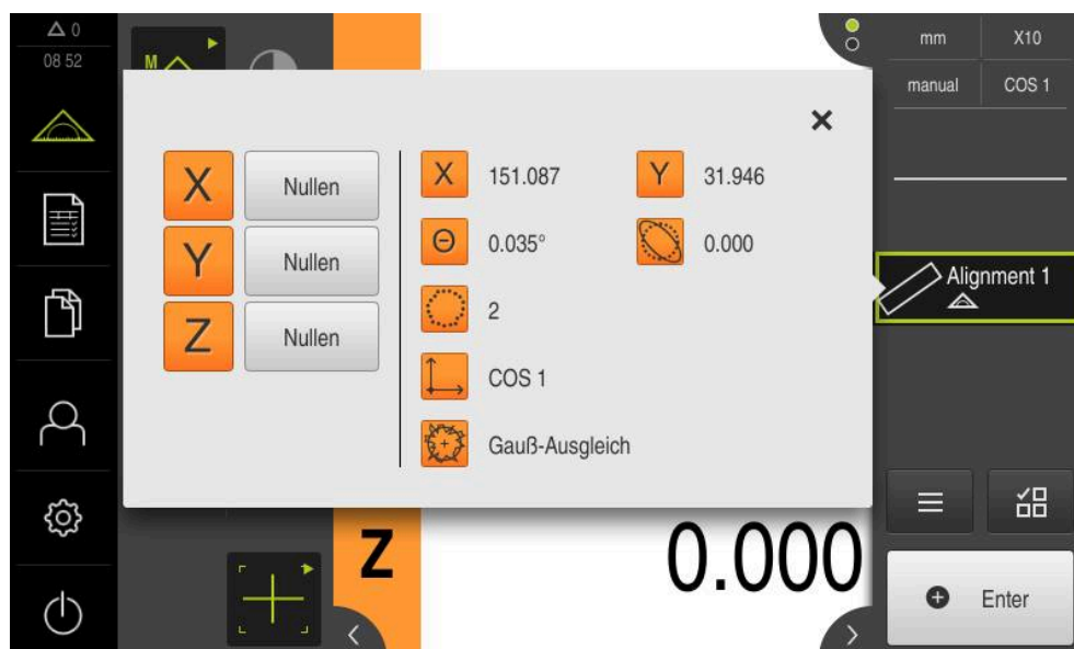
Abbildung 44: Element Ausrichtung in der Elementliste mit Messergebnisvorschau
