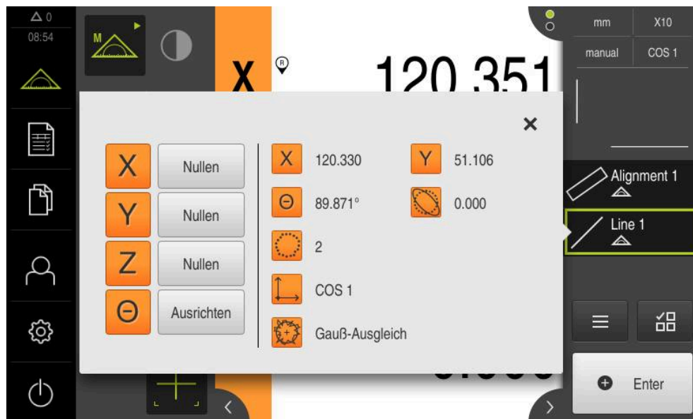
Abbildung 45: Element Gerade in der Elementliste mit Messergebnisvorschau
