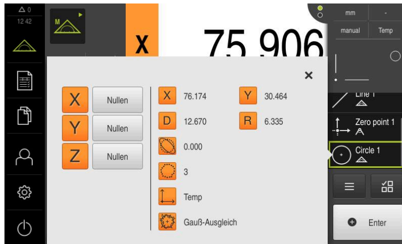
Abbildung 57: Element Kreis mit Messergebnisvorschau bei Messpunktaufnahme ohne Sensor
