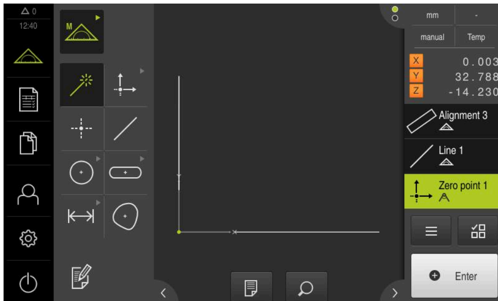
Abbildung 38: Arbeitsbereich mit angezeigtem Nullpunkt im Koordinatensystem
