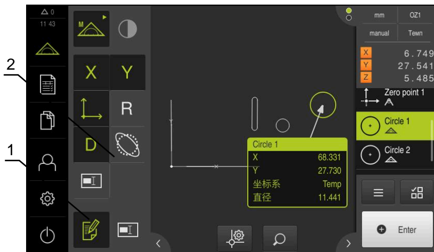
图 21: 几何元素视图中显示的带注释的几何元素
