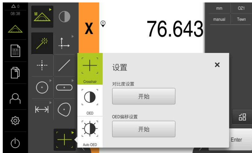
图 18: OED测量工具的 设置 对话框
