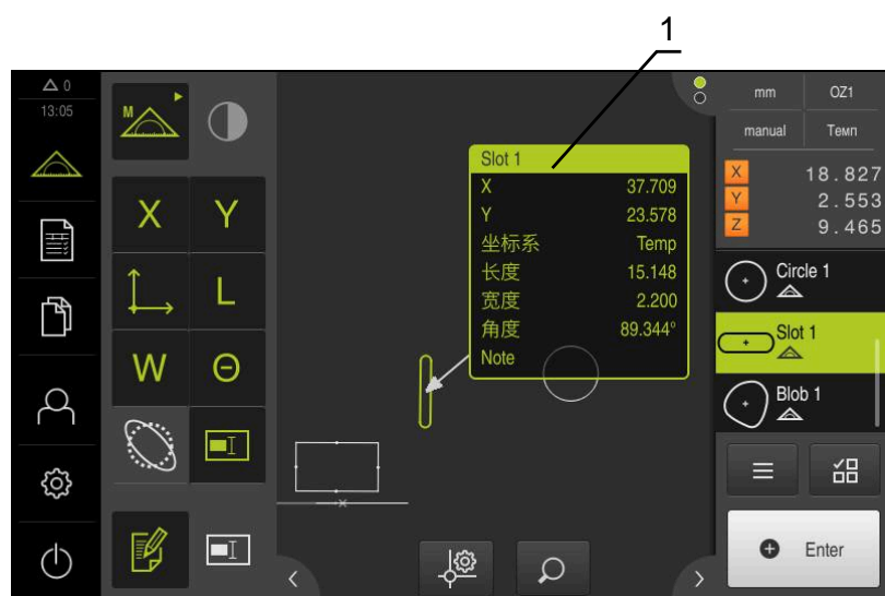
图 73: 带几何元素测量信息的几何元素视图
