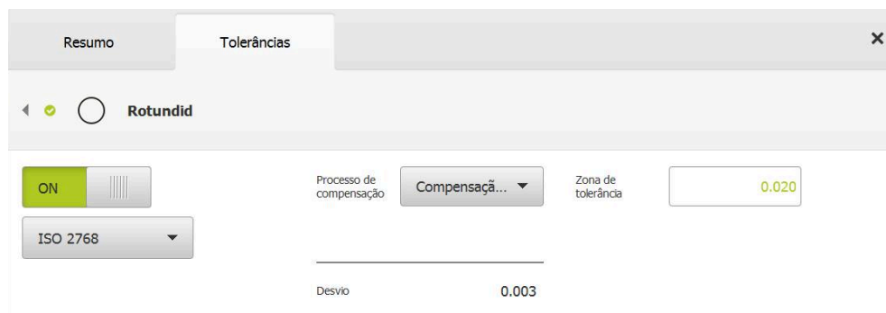
Figura 69: Resumo das Tolerâncias de forma com tolerância de Rotundid ativada segundo ISO 2768
