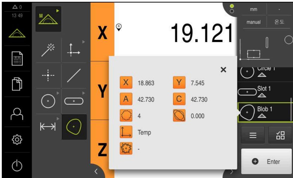
Şekil 37: Eleman Ağırlık merkezi ; Eleman önizlemesi eleman listesi
