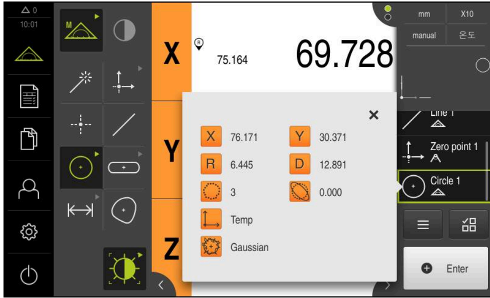
Şekil 54: Etkin OED ölçüm aleti ile ölçüm noktası kaydında Eleman özizlemesi bulunan Daire elemanı
