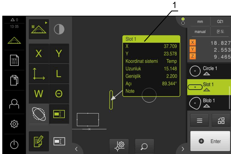
Şekil 73: Bir elemana ilişkin ölçüm bilgilerini içeren eleman görünümü
