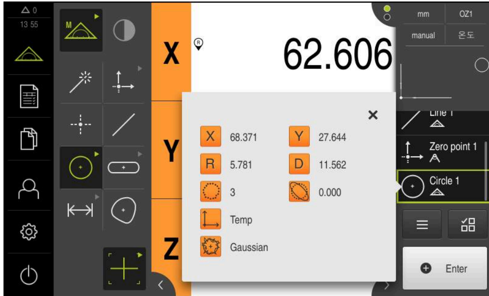
Şekil 53: Artı imleci OED ölçüm aleti ile ölçüm noktası kaydı için Daire elemanı ve Eleman önizlemesi
