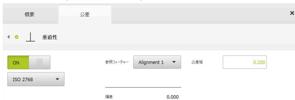
図 71: ISO 2768 に準拠する「垂直性」公差が有効化された「方向公差」一覧
