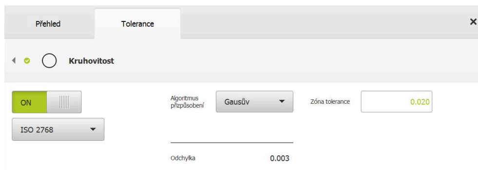
Obrázek 69: Přehled Tolerance tvaru s aktivovanou tolerancí Kruhovitost podle ISO 2768
