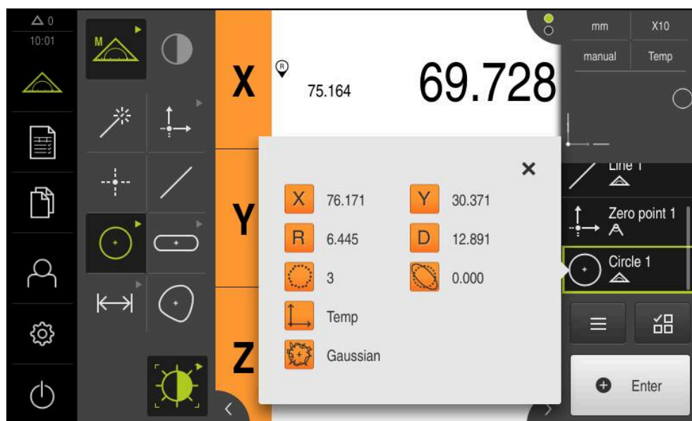
Obrázek 54: Prvek Kružnice s Náhled prvku při snímání měřících bodů s aktivním OED-měřicím nástrojem
