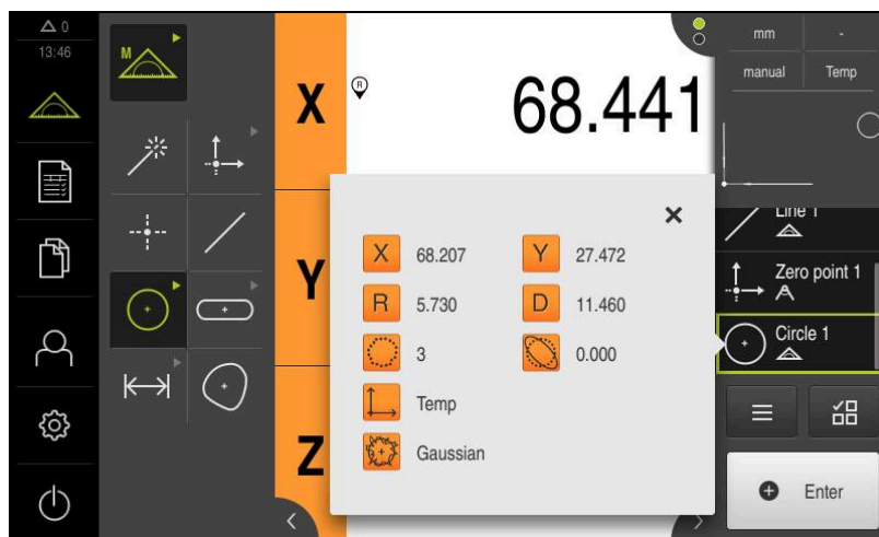
Obrázek 35: Prvek Kružnice v seznamu prvků s Náhled prvku
