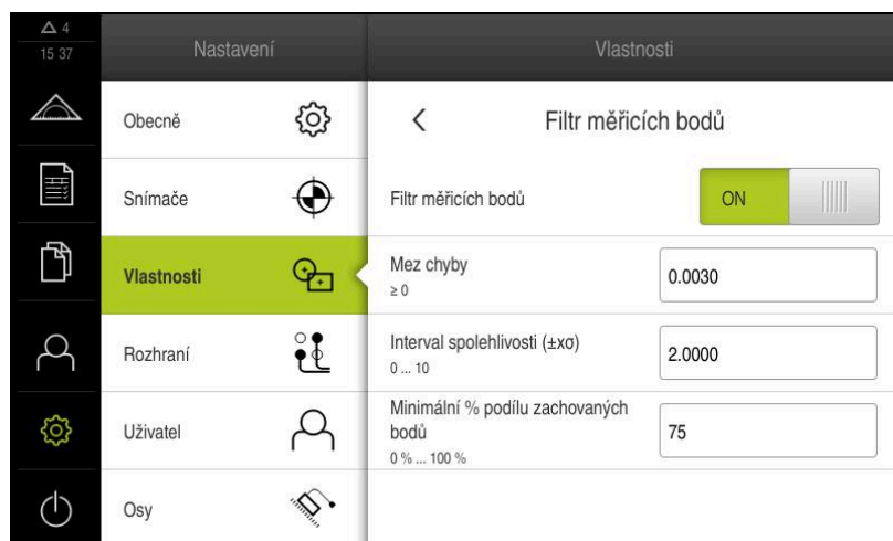
Obrázek 85: Nastavení filtru měřicích bodů
