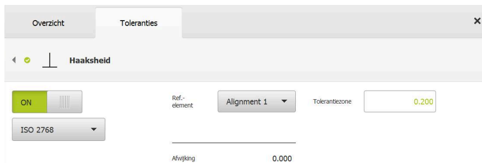
Afbeelding 71: Overzicht Richtingstoleranties met geactiveerde tolerantie Haaksheid volgens ISO 2768
