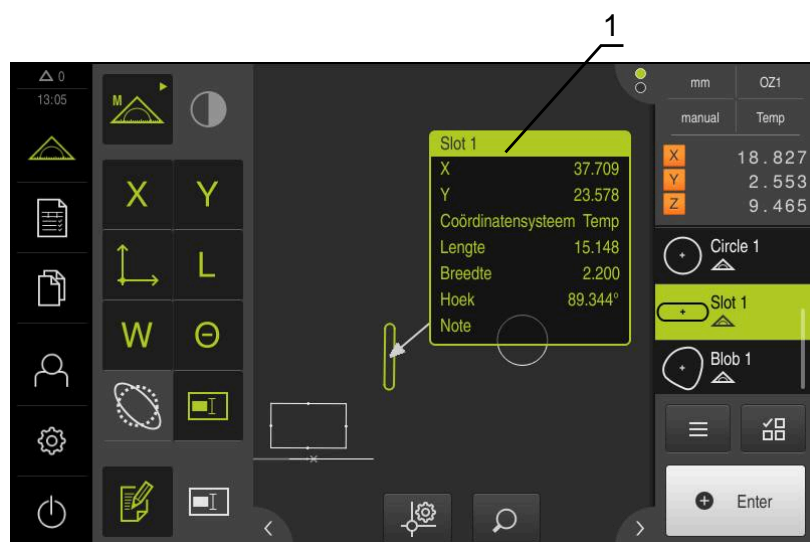
Afbeelding 73: Elementenaanzicht met informatie over een element
