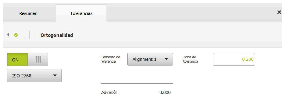
Figura 71: Resumen de Tolerancias de dirección con tolerancia activada Ortogonalidad según ISO 2768
