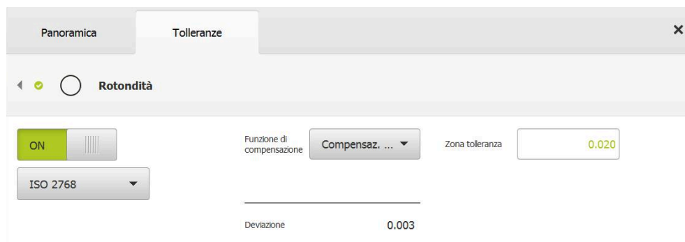
Figura 69: panoramica Tolleranze di forma con tolleranza attiva Rotondità secondo ISO 2768
