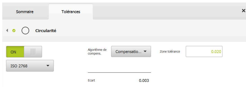
Figure 69 : Vue d'ensemble des Tolérances de forme avec la tolérance Circularité activée selon ISO 2768
