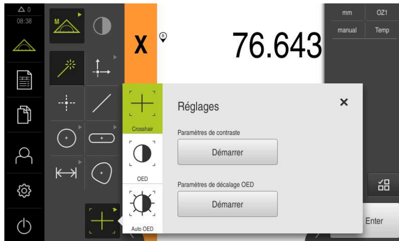
Figure 18 : Dialogue Réglages pour les outils de mesure OED
