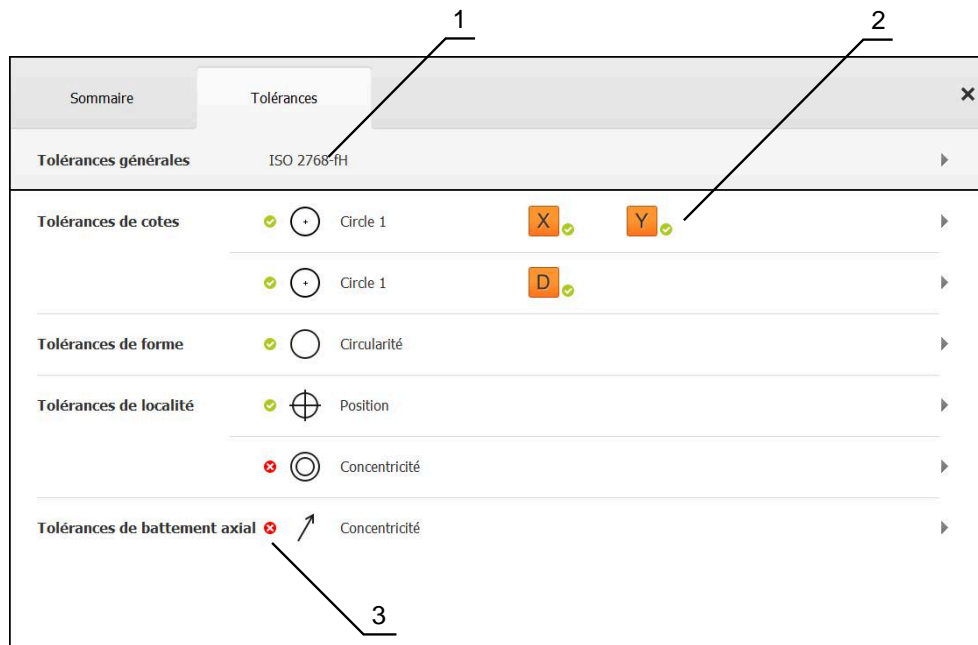
Figure 49 : La boîte de dialogue Détails avec l'onglet Tolérances
