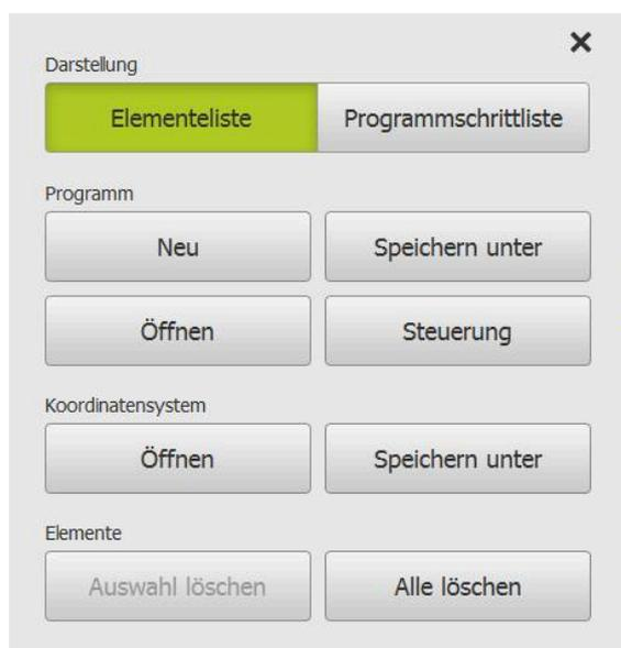
Abbildung 29: Bedienelemente von Messprogrammen im Dialog Zusatzfunktionen
