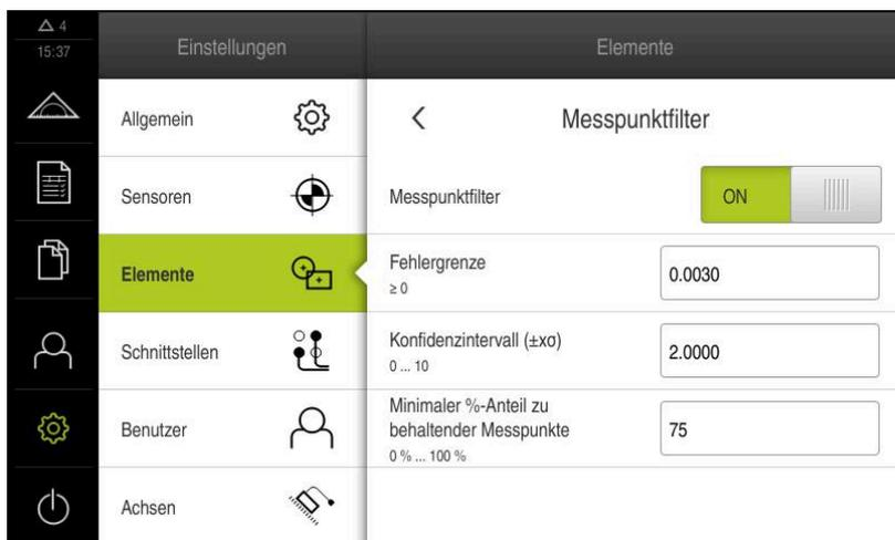
Abbildung 85: Einstellungen des Messpunktfilters
