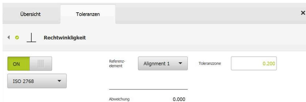
Abbildung 71: Übersicht **Richtungstoleranzen** mit aktivierter Toleranz **Rechtwinkligkeit** nach **ISO 2768**
