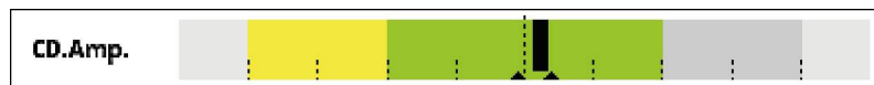
Illustration 27 : Amplitude CD 1 V CC (écart entre les traits de graduation : 0,1 V CC )
