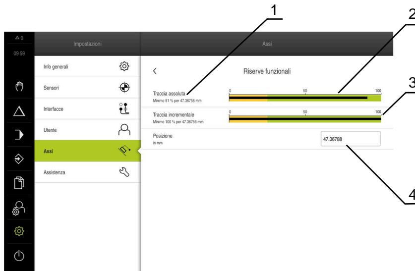
Figura 28: Esempio di riserve funzionali di un tastatore di misura
