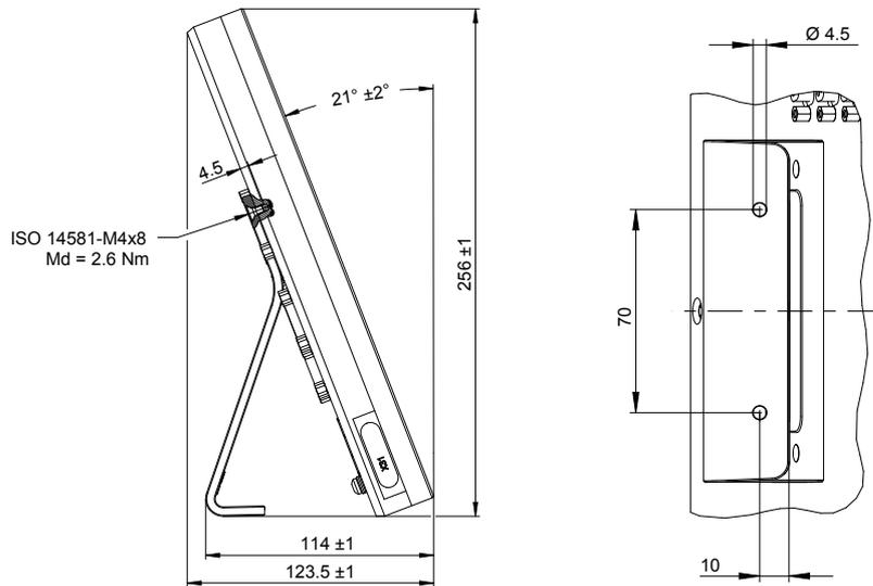
Figura 33: Quote dell'apparecchiatura con base di supporto Single-Pos
