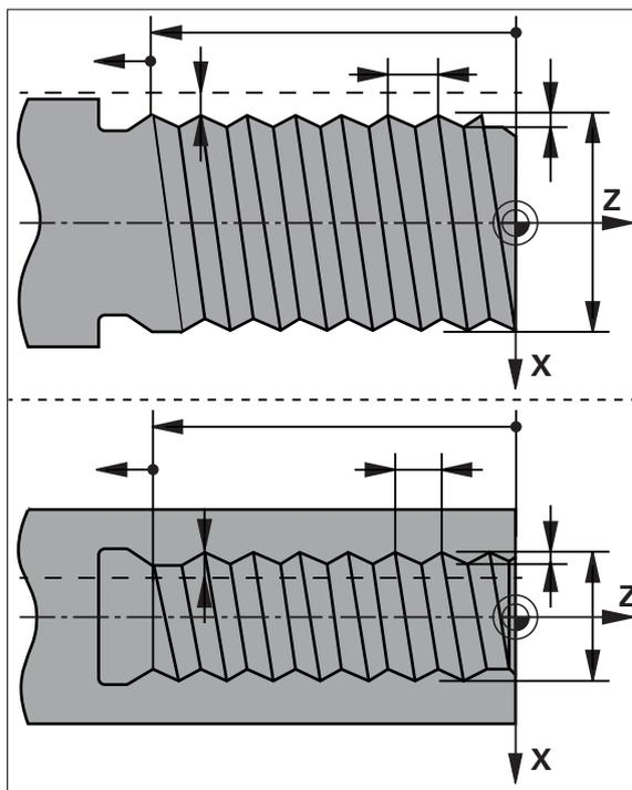
Figura 52: Rappresentazione schematica del blocco **Filettatura (estesa)**
