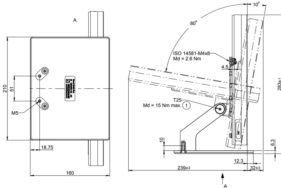
Figura 35: Quote dell'apparecchiatura con base di supporto Multi-Pos
