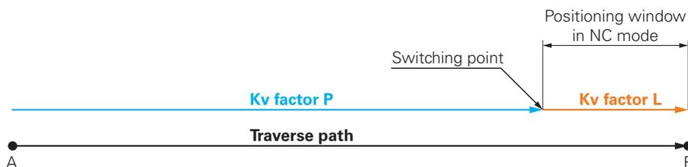
Per il percorso di traslazione è attivo il **Fattore Kv P**. Non appena i valori nominali del regolatore di posizione determinati dalle rampe di accelerazione raggiungono la **Finestra di posizionamento in modalità NC**, viene eseguita la commutazione sul **Fattore Kv L**. Il regolatore di posizione riceve la posizione di destinazione come nuovo valore nominale.
