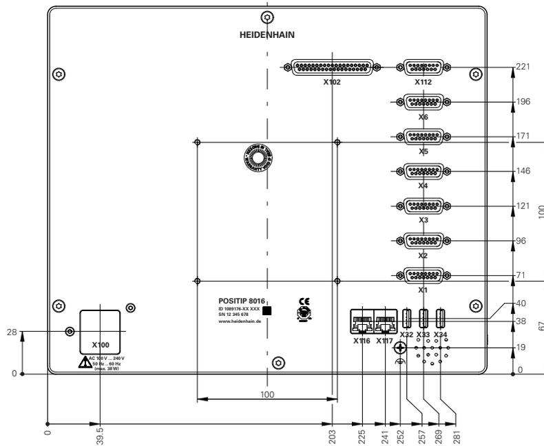
Figura 31: Quotatura del retro per apparecchiature con ID 1089176-xx
