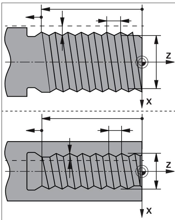
Figura 41: Rappresentazione schematica del blocco **Filettatura (semplice)**
