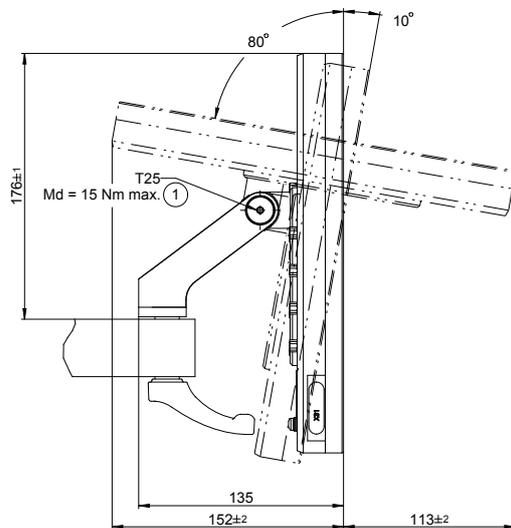
Figura 36: Quote dell'apparecchiatura con supporto Multi-Pos
