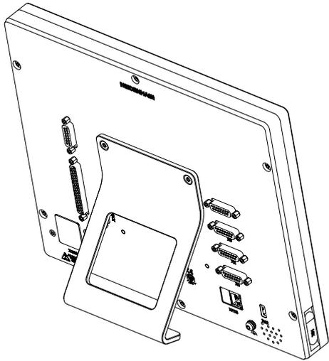
Figura 13: apparecchiatura montata su base di supporto Single-Pos
