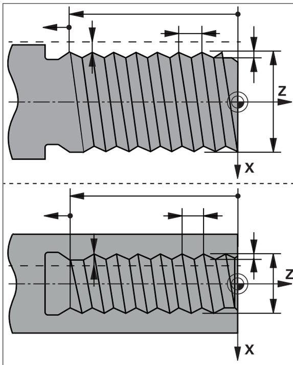
Figura 42: Rappresentazione schematica del blocco **Filettatura (estesa)**
