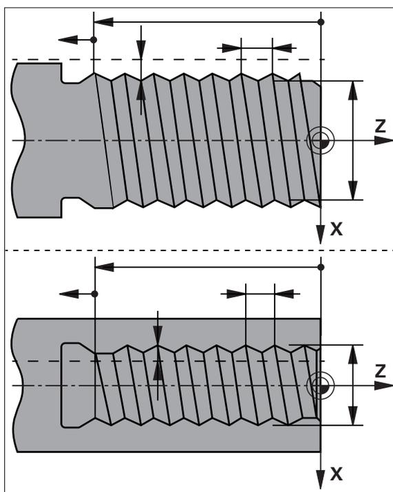
Figura 51: Rappresentazione schematica del blocco **Filettatura (semplice)**
