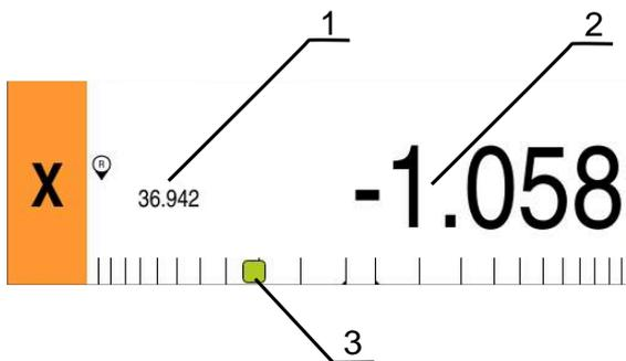
Figura 45: vista **Percorso residuo con posizione** con aiuto grafico di posizionamento
