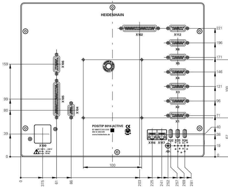
Figura 32: Quotatura del retro per apparecchiature con ID 1089177-xx
