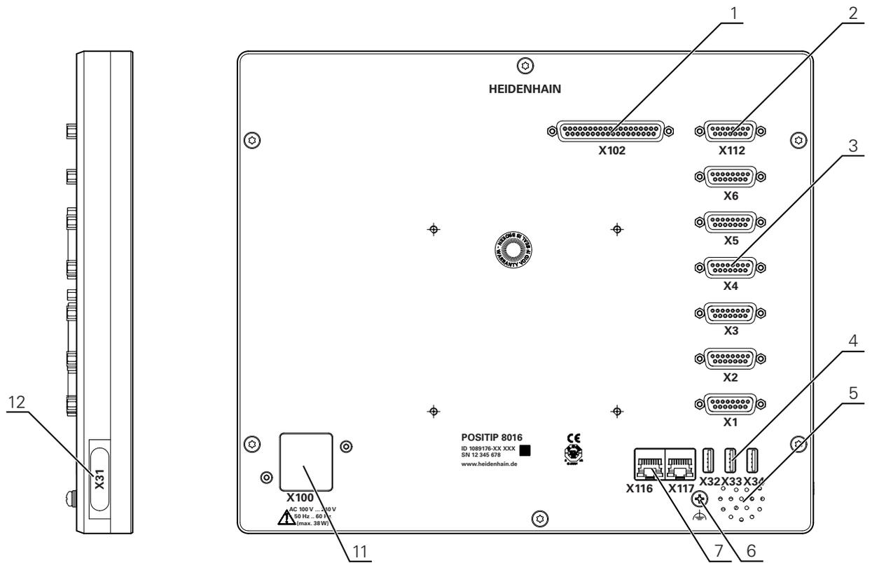
Figura 21: Retro per apparecchiature con ID 1089176-xx
