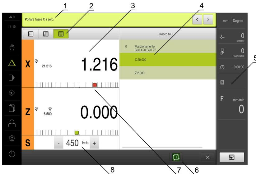
Figura 43: Esempio di blocco in modalità **MDI**
