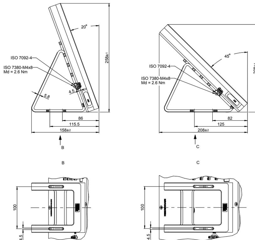
Figura 34: Quote dell'apparecchiatura con base di supporto Duo-Pos
