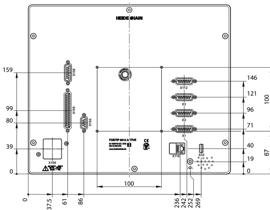
Figura 30: Quotatura del retro dell'apparecchiatura
