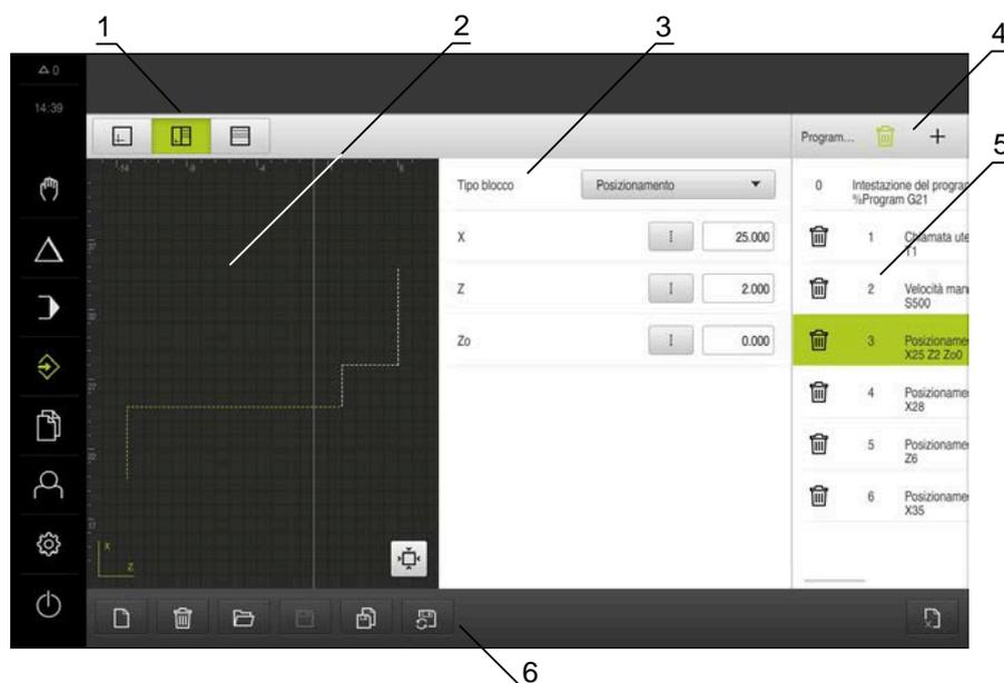
Figura 47: esempio di programma in modalità **Programmazione**
