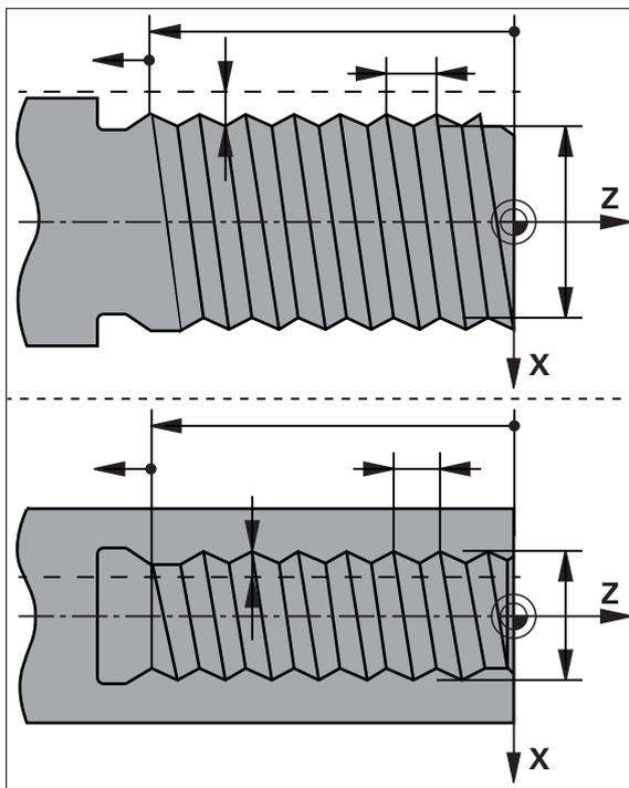
Figura 45: Rappresentazione schematica del blocco **Filettatura (semplice)**
