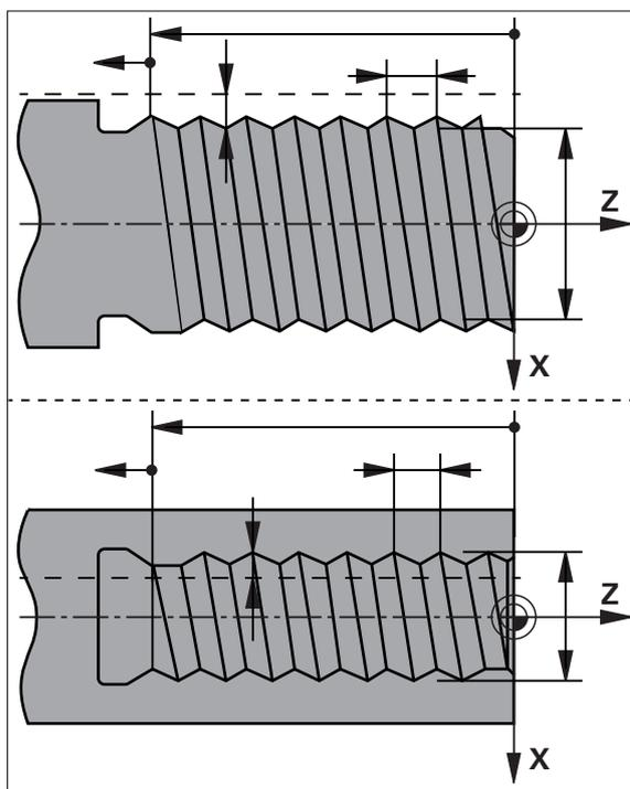
Figura 35: Rappresentazione schematica del blocco **Filettatura (semplice)**
