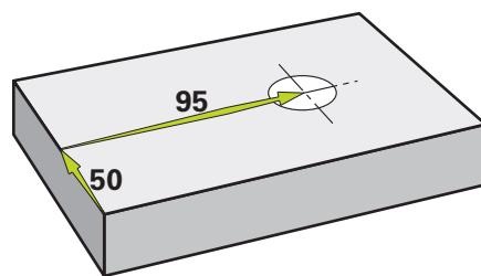
图 65: 示例工件 – 钻通孔
