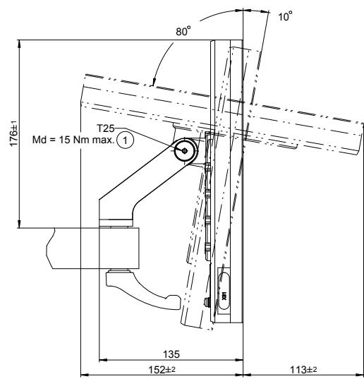
图 41: 带多位安装座的产品尺寸
