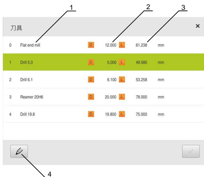
图 29: 带刀具参数的刀具表
