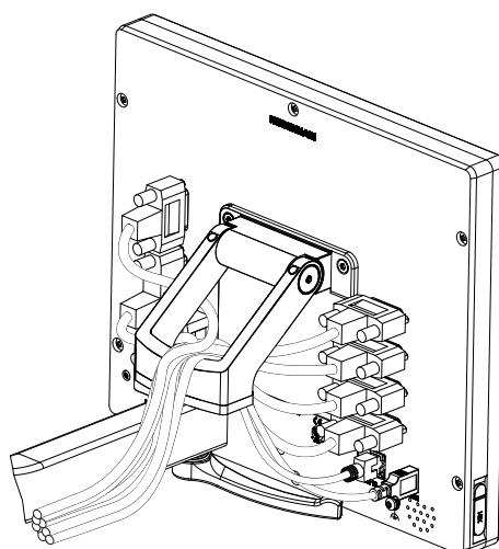
图 23: 电缆在多位安装座上的走线
