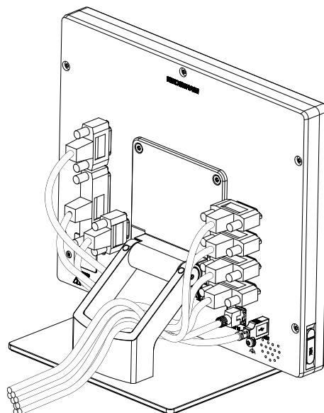
图 21: 电缆在多位支架上的走线
