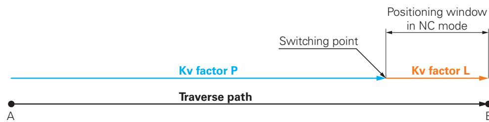
**Kv系数P**对行程路径有效。一旦位置控制单元用加速度斜度计算的名义值达到**NC操作模式下的定位窗口**，触发切换到**Kv系数L**。目标位置以新名义值传输给位置控制单元。
