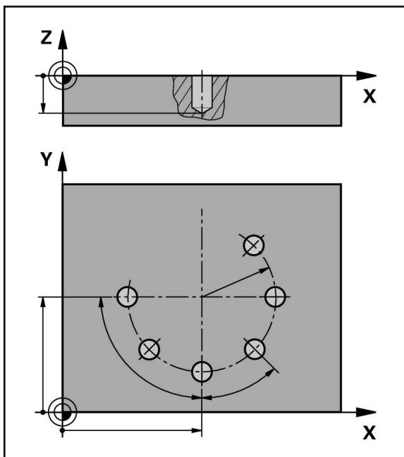
图 57: 螺栓孔程序段的图形显示
