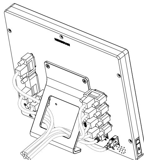
图 17: 电缆在单位支架上的走线
