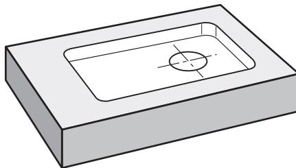
图 67: 示例工件 – 加工配合孔
