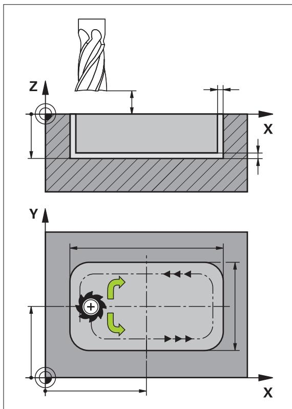
图 47: 矩形型腔程序段的图形显示
