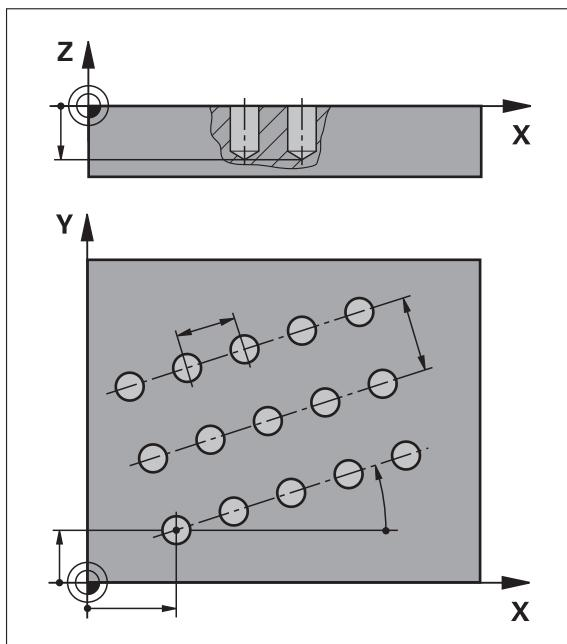
图 46: 排孔程序段的图形显示
