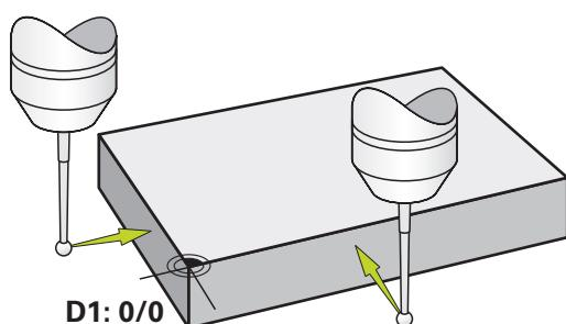
图 64: 示例工件 – 确定预设点D1
