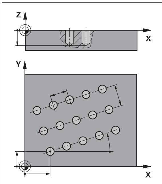
图 58: 排孔程序段的图形显示
