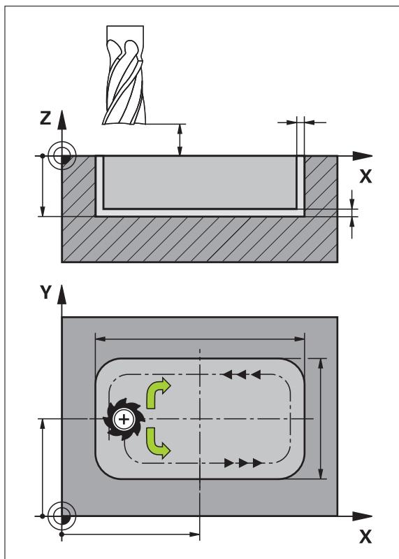
图 59: 矩形型腔程序段的图形显示
