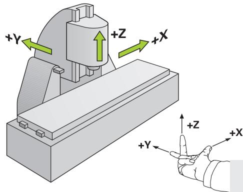
图 26: 矩形坐标系与机床轴之间的对应关系
