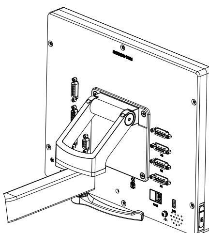
图 22: 将产品安装在多位安装座上
