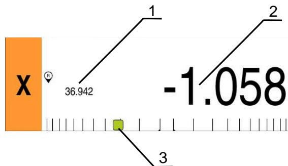
图 50: 带图形定位辅助的余程位置视图
