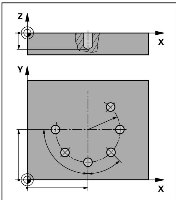
图 45: 螺栓孔程序段的图形显示
