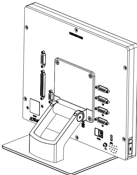
图 20: 将产品安装在多位支架上
