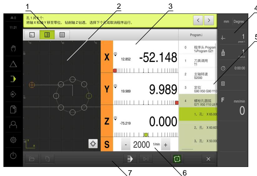
图 53: 程序运行操作模式下的程序举例
