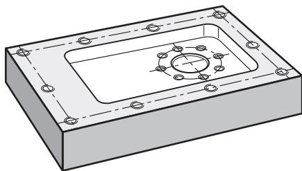
图 69: 示例工件 – 编程螺栓孔阵列和排孔
