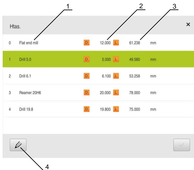
Figura 29: Tabla de herramientas con parámetros de herramienta
