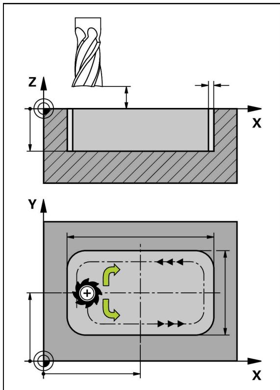
그림 57: 사각 포켓 블록의 계통 표시
