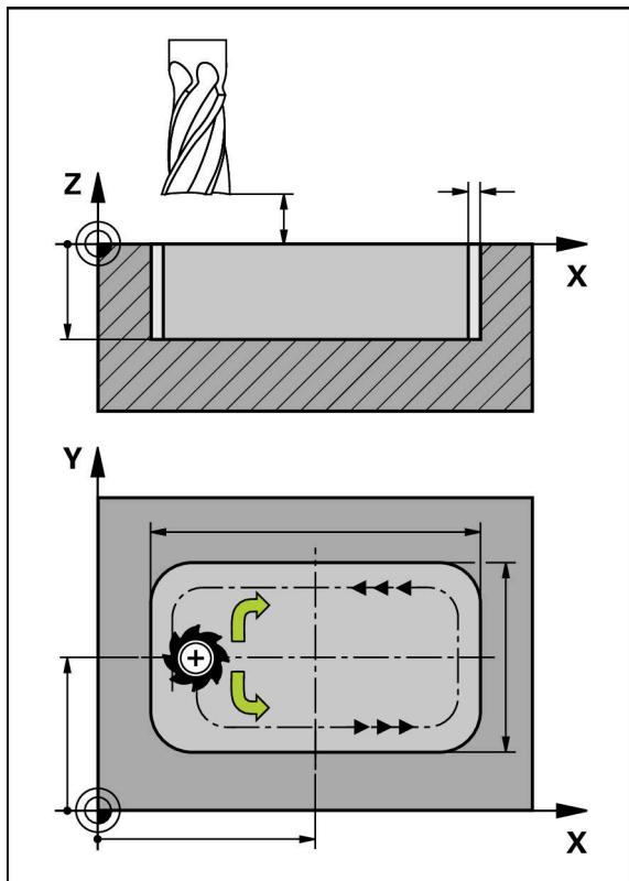
그림 45: 사각 포켓 블록의 계통 표시
