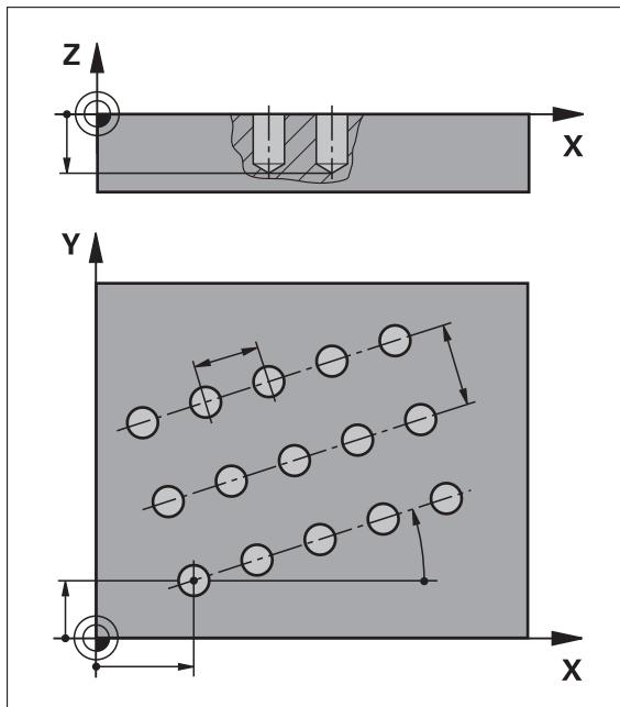
그림 56: 홀 행 블록의 계통 표시
