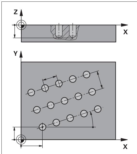
그림 44: 홀 행 블록의 계통 표시
