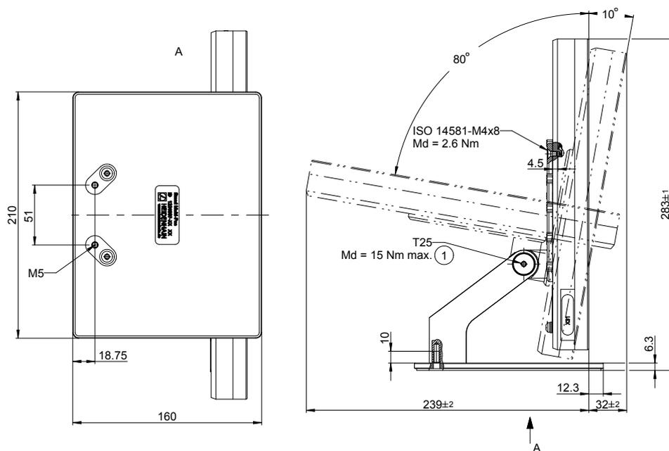
Рисунок 37: Размеры устройства с подставкой Multi-Pos
