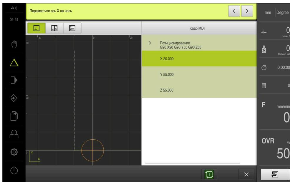
Рисунок 49: Пример – Выполнение кадра ручного ввода данных с коэффициентом масштабирования
