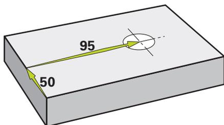
Рисунок 62: Образцовая деталь – Изготовление сквозного отверстия
