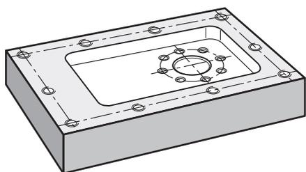
Рисунок 68: Образцовая деталь – Изготовление отверстий на окружности и ряда из отверстий
