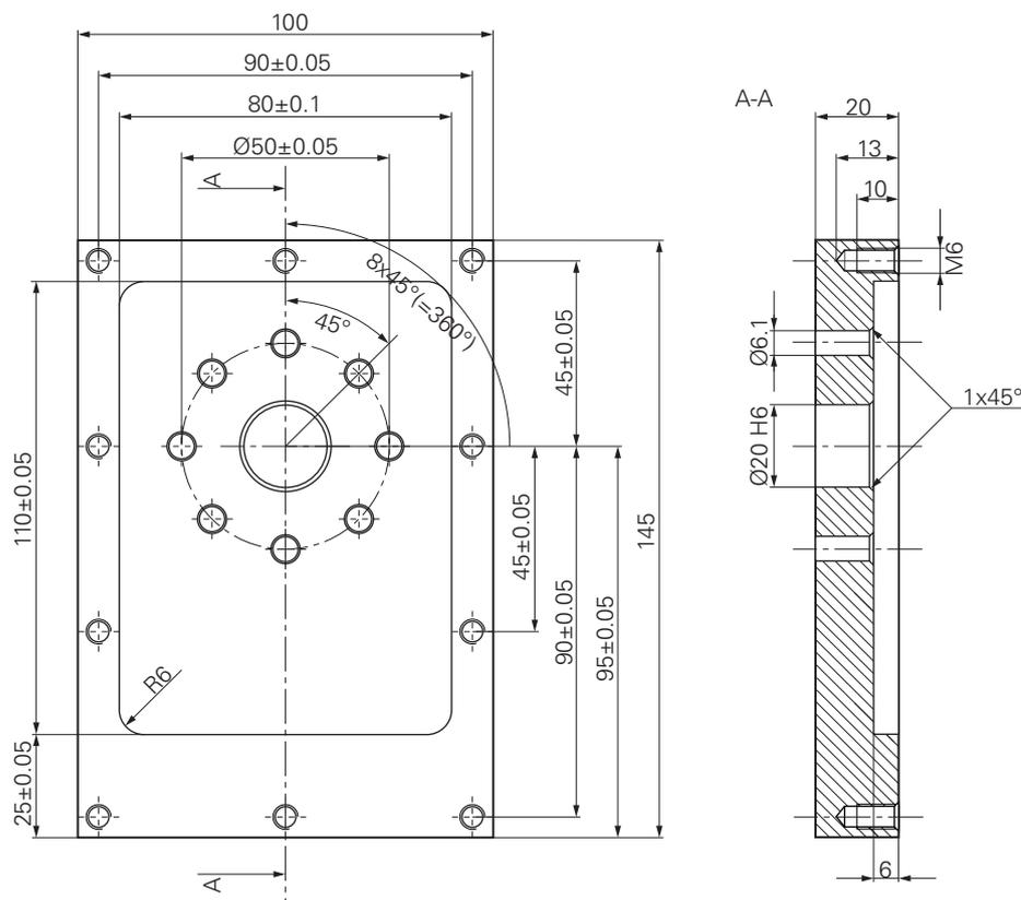
Рисунок 60: Образцовая деталь – технический чертёж
