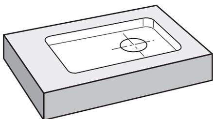
Рисунок 64: Образцовая деталь – изготовить посадочное место
