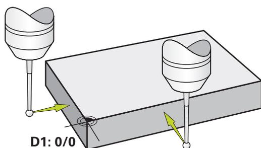
Рисунок 61: Образцовая деталь – Определить точку привязки D1
