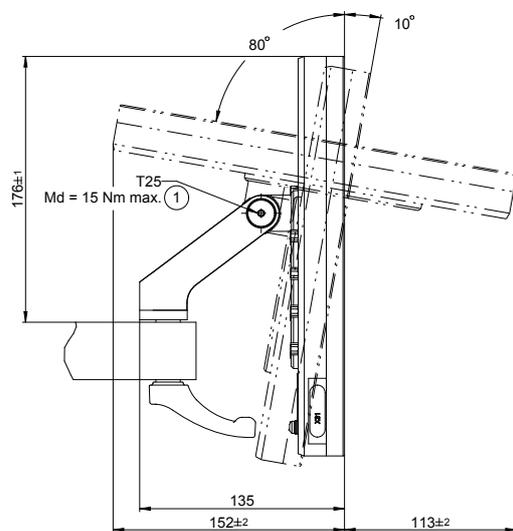
Рисунок 38: Размеры устройства с креплением Multi-Pos
