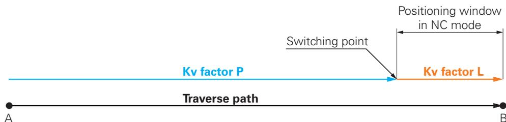
При движении действует **Kv-фактор P**. Как только заданное значение регулятора положения, определяемое из кривой ускорения, достигает **Окно позиционирования в режиме управления**, то переключается на **Kv-фактор L**. Регулятор положения получает целевое положение в качестве нового заданного значения.
