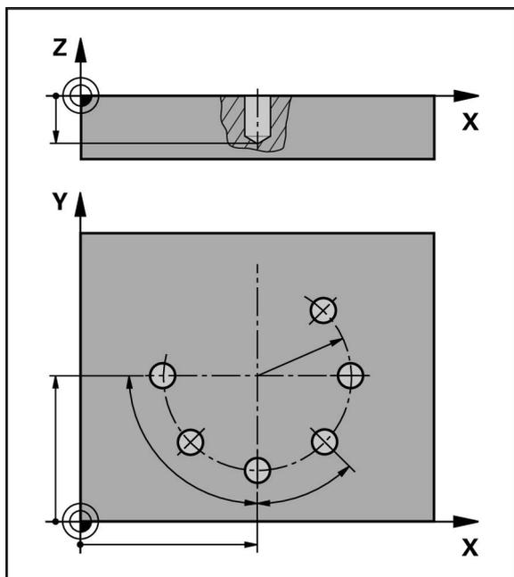
Рисунок 54: Схематичное представление кадра Отверстия на окружности
