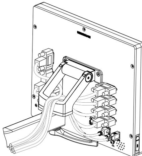
Рисунок 23: Кабельный желоб на держателе Multi-Pos
