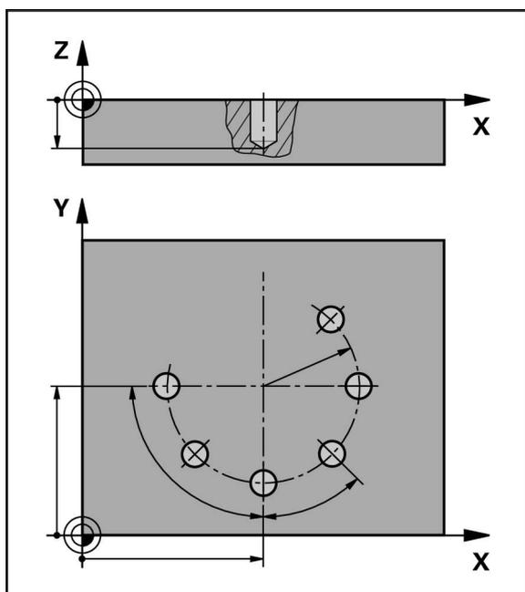
Рисунок 42: Схематичное представление кадра Отверстия на окружности
