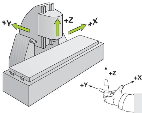
Рисунок 25: Привязка прямоугольной системы координат к осям станка
