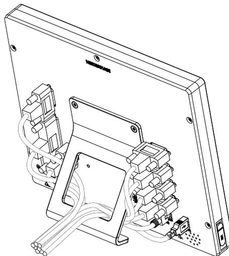
Рисунок 17: Кабельный желоб на стойке Single-Pos
