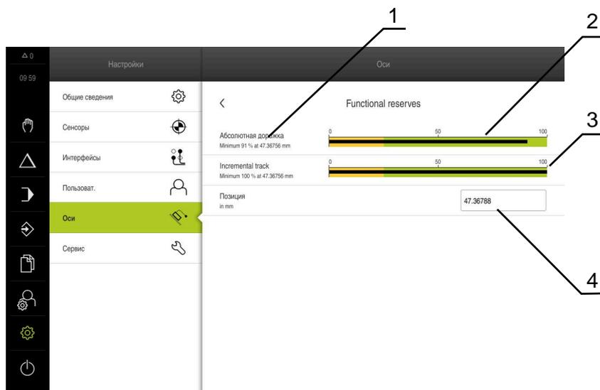
Рисунок 32: Пример запаса работоспособности для некоторого датчика
