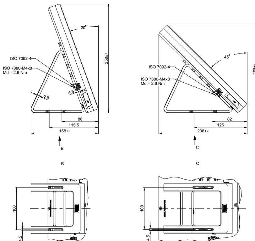
Рисунок 36: Размеры устройства с подставкой Duo-Pos
