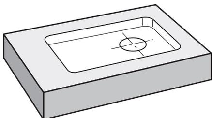
Рисунок 63: Образцовая деталь – Изготовление прямоугольного кармана
