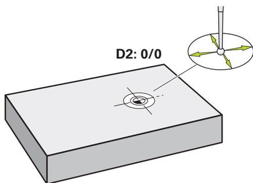
Рисунок 65: Образцовая деталь – Определить точку привязки D2
