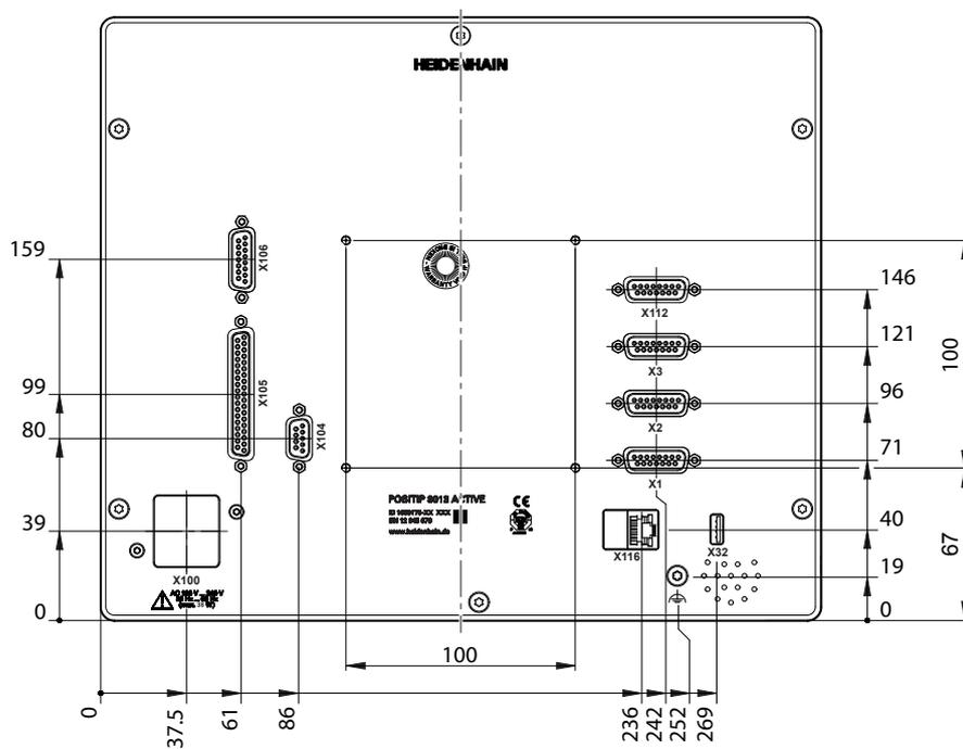
Рисунок 34: Размеры задней панели устройств
