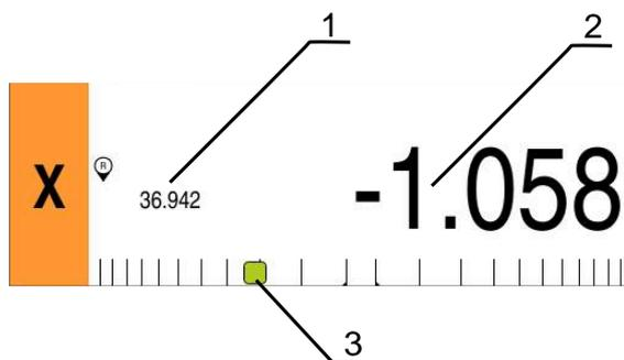
Рисунок 47: Отображение **Ост. путь и позиция** с графической помощью при позиционировании
