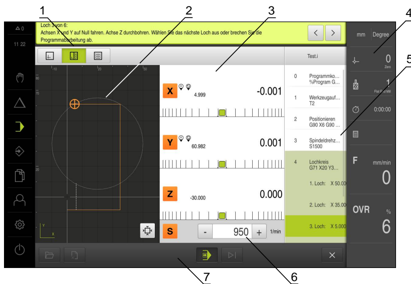
图 44: 程序运行操作模式下的程序举例
