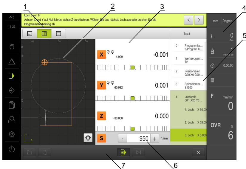
図 44: 「プログラムラン」操作モードのプログラム例
