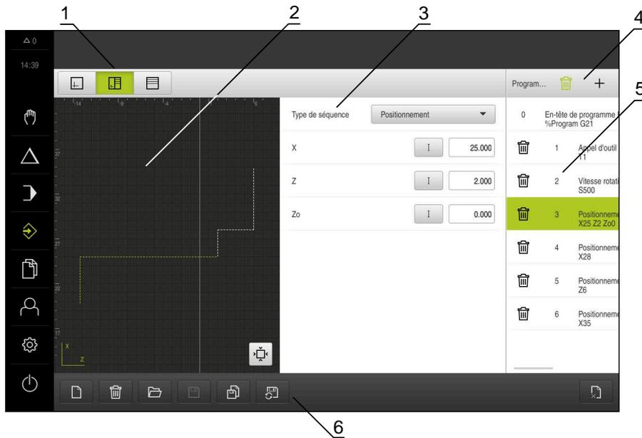
Illustration 8 : Menu **Programmation** avec fenêtre de simulation ouverte
