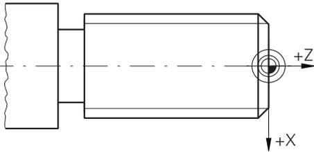
Illustration 17 : Exemple de pièce – Détermination du point d'origine
