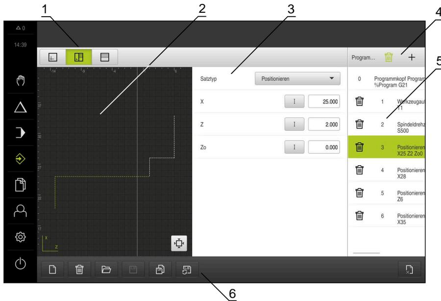
Abbildung 8: Menü **Programmierung** mit geöffnetem Simulationsfenster
