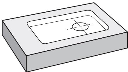
图 19: 示例工件 – 加工矩形型腔
