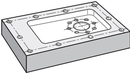
图 22: 示例工件 – 编程螺栓孔阵列和排孔
