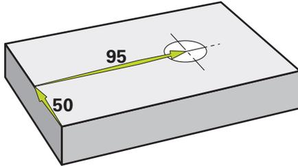
图 18: 示例工件 – 钻通孔
