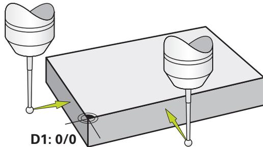
Figure 17 : Exemple de pièce – Détermination du point d'origine D1
