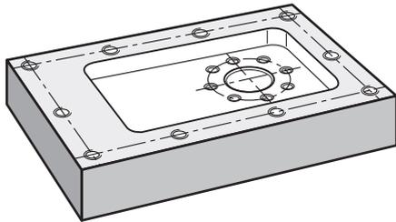
Figure 24 : Exemple de pièces – Usinage d'un cercle de trous et d'une rangée de trous
