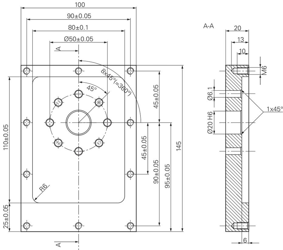
Figure 16 : Exemple de pièce – Dessin technique
