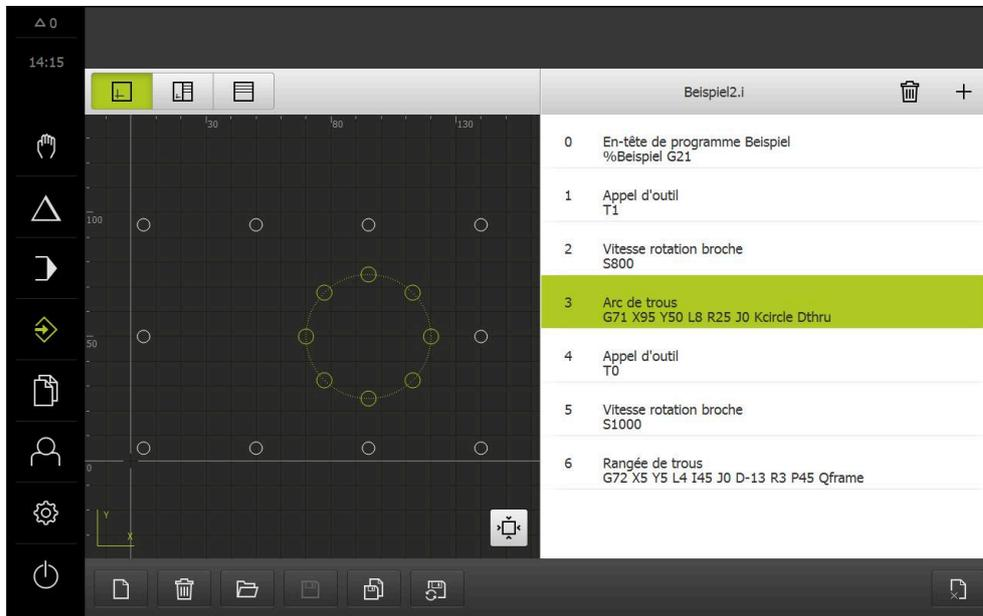
Figure 23 : Exemple de pièce -Fenêtre de simulation
